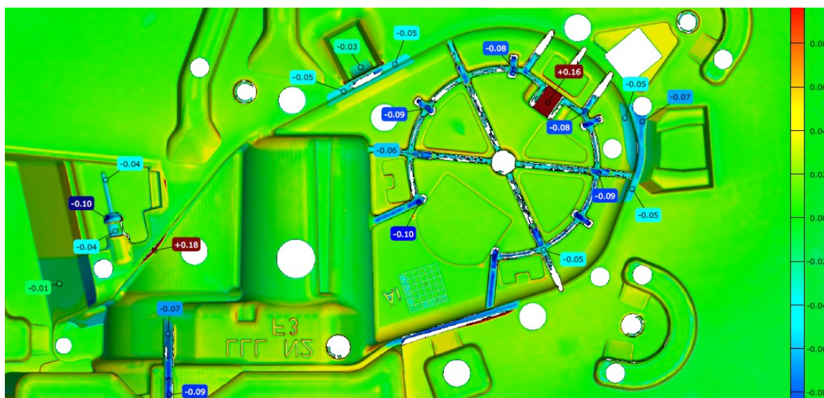
Slika 75. Greške prilikom EDM: preduboko erodirano (plavo), višak materijala (crveno)
