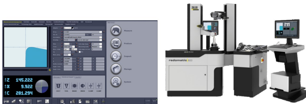
Slika 32. Uređaj za prednamještanje alata tvrtke Zoller [20]
