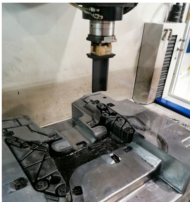
Slika 73. Primjer pozicioniranja prije erodiranja
