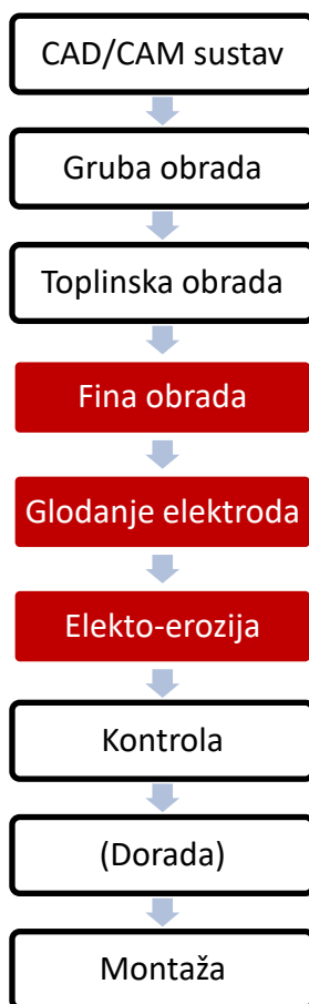
Slika 64. Algoritam rada FMS-a na primjeru proizvodnje matrica
