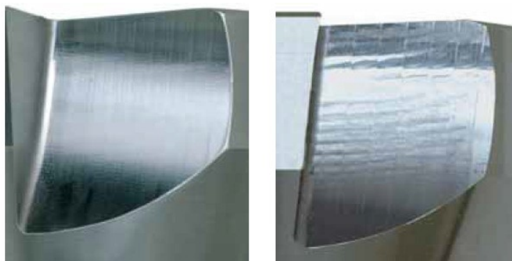
Slika 17. Obradena površina s VDP steznim sustavom (lijevo) i bez (desno) [12]
