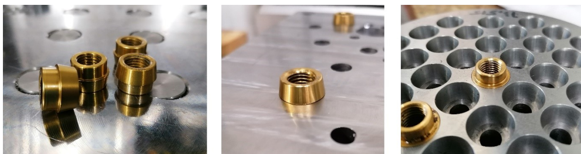
Slika 46. Prsteni za stezanje i pozicioniranje
