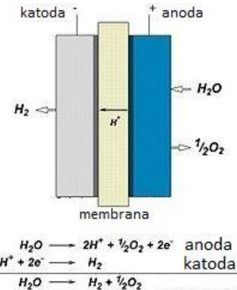
**Slika 3.1** Princip rada PEM elektrolizatora [12]
