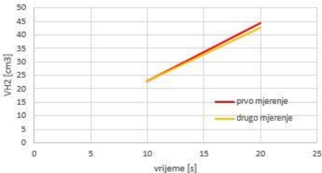
**Slika 5.12** Proizvodnja vodika pri  $U = 13 \text{ V}$ ;  $I = 2,5 \text{ A}$
