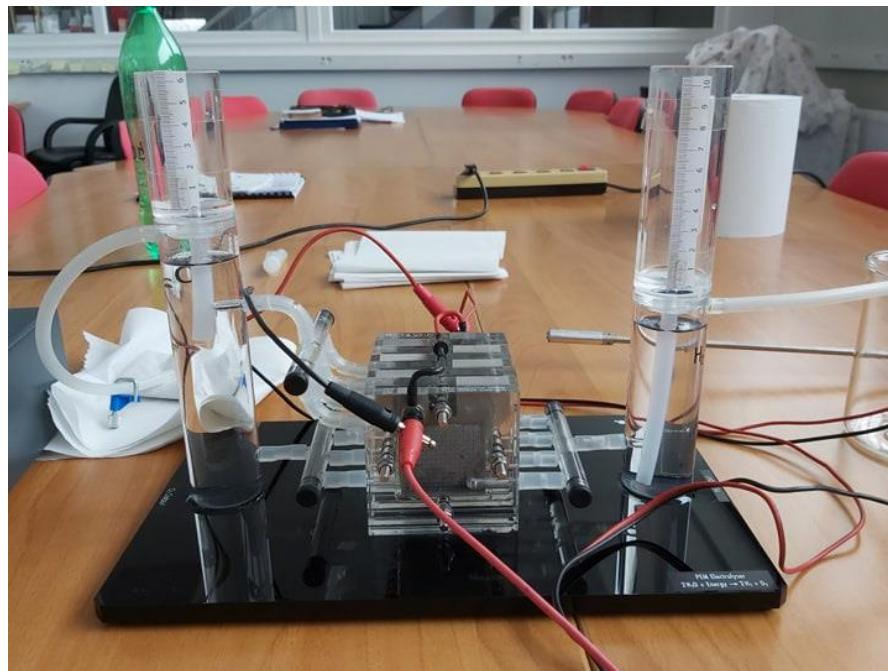
**Slika 5.2** PEM elektrolizator
