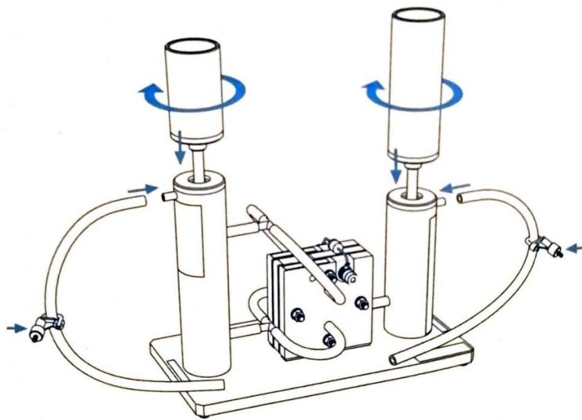
**Slika 4.2** Sastavljanje elektrolizatora [14]
