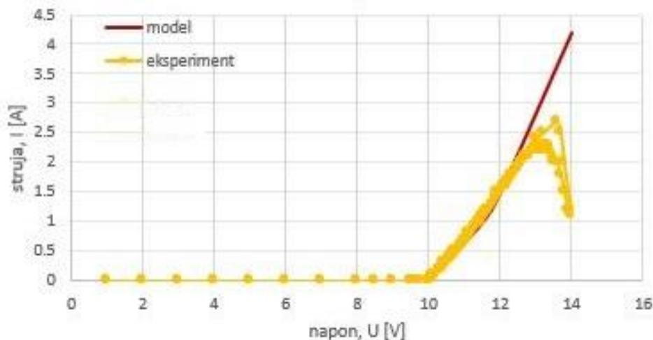
Slika 5.5 U-I karakteristika pri  $t = 16 \text{ } ^\circ\text{C}$
