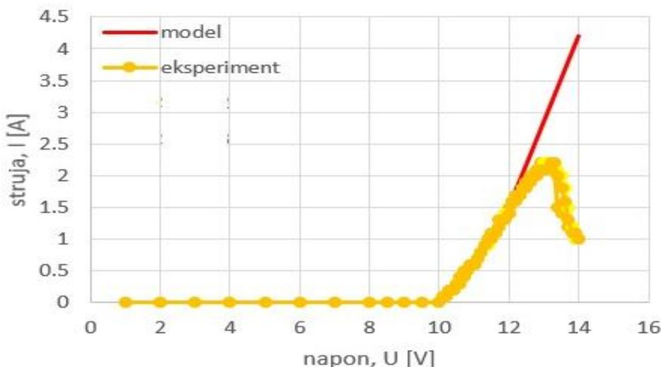
Slika 5.6 U-I karakteristika pri  $t = 23 \text{ } ^\circ\text{C}$
