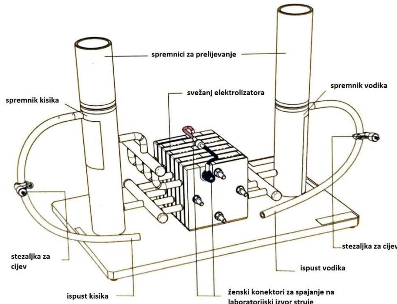
**Slika 4.1** Komponente elektrolizatora [14]
