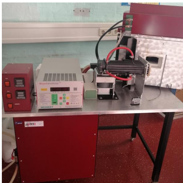
Slika 7. Hibridna peć za mikrovalno sinteriranje
