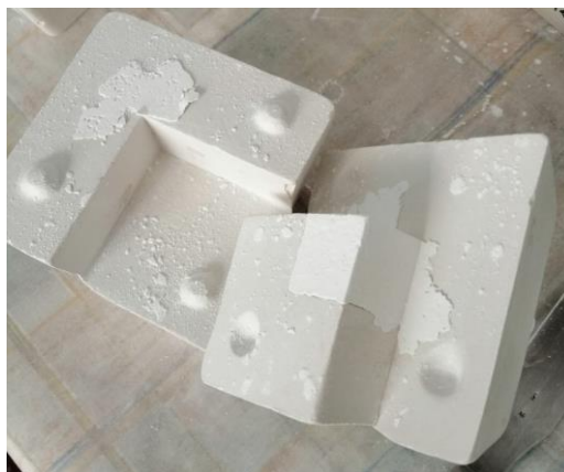
Slika 2. Otvaranje gipsanih kalupa nakon sušenja suspenzije
