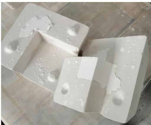
**Slika 2. Otvaranje gipsanih kalupa nakon sušenja suspenzije**
