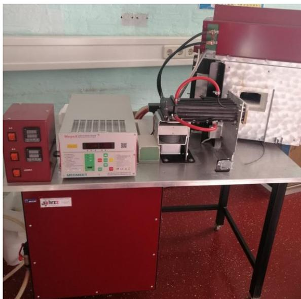
Slika 7. Hibridna peć za mikrovalno sinteriranje
