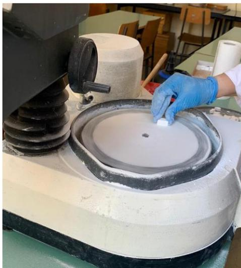
**Slika 5. Brušenje sirovaca**
