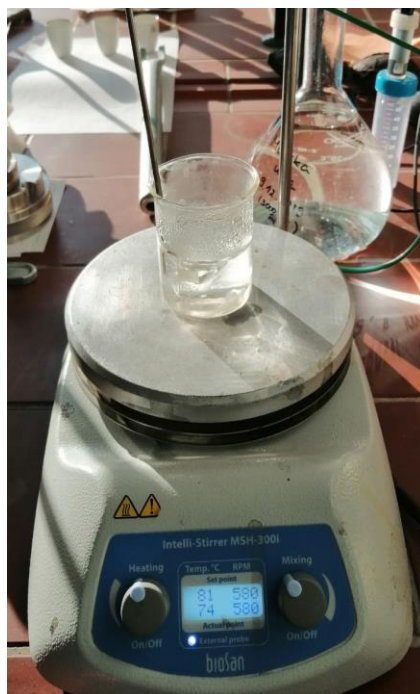
Slika 1. Otapanje PVA u 40 ml vode
