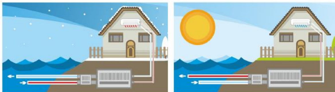
Slika 4. Dizalica topline morska voda – voda u režimu grijanja (lijevo) i režimu hlađenja (desno) [6]
