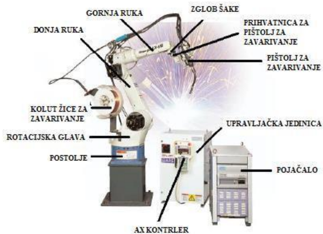
Slika 4. Robotizirana zavarivačka stanica[12]
