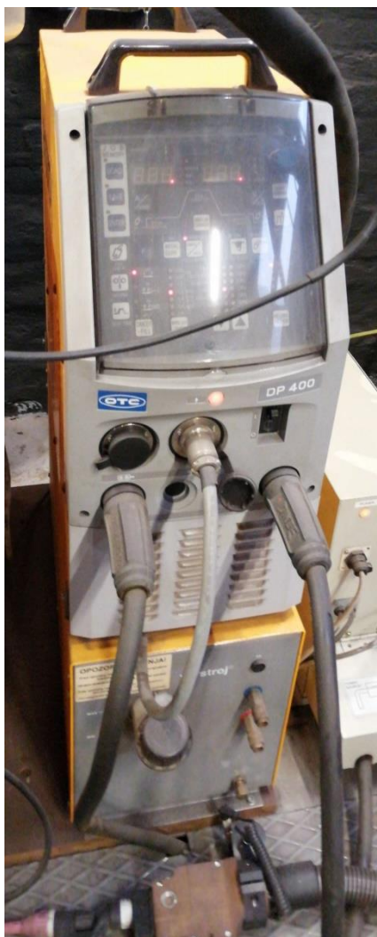
Slika 20. OTC Daihen Varstroj DP 400
