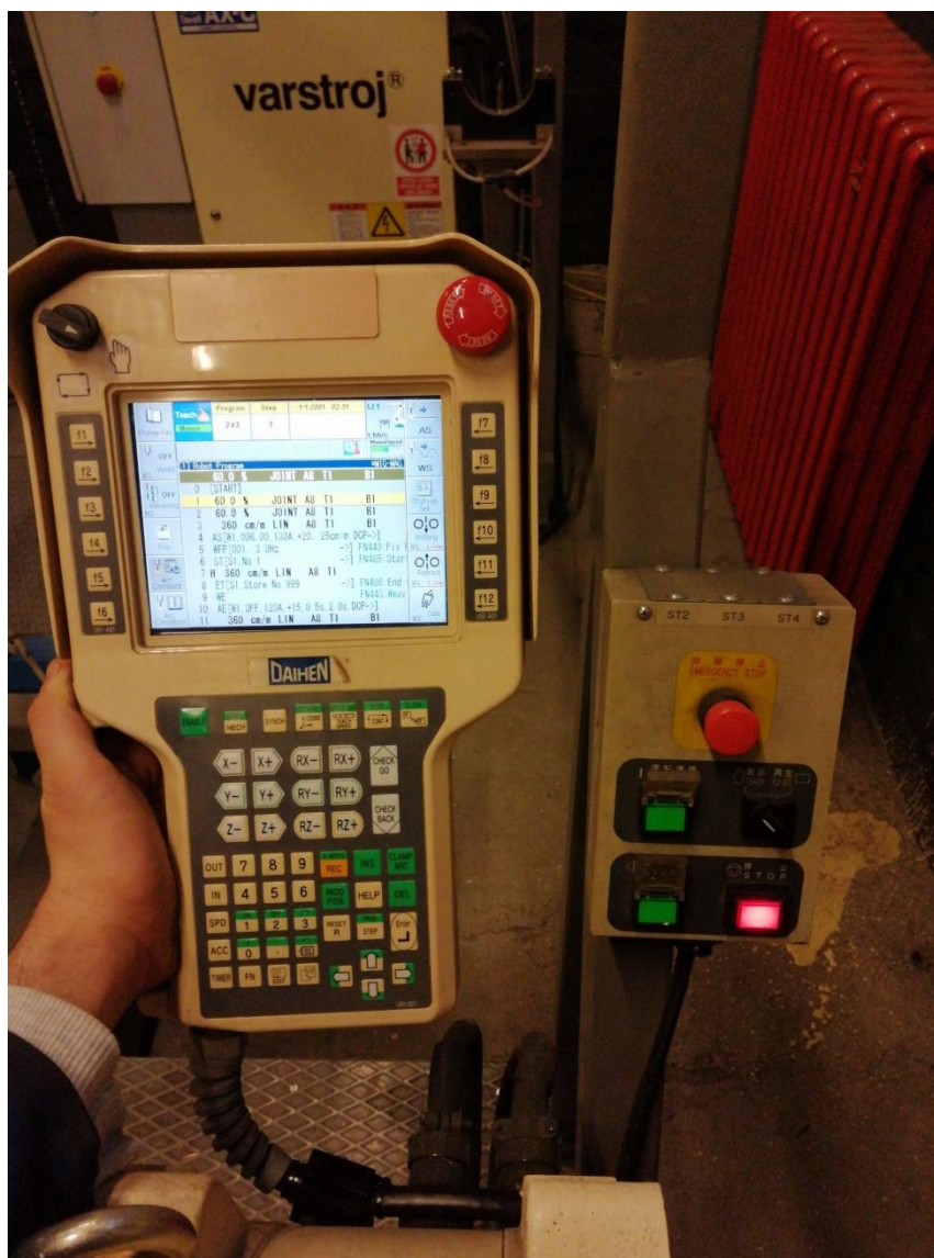
Slika 19. Privjesak za učenje i kontroler AX - C
