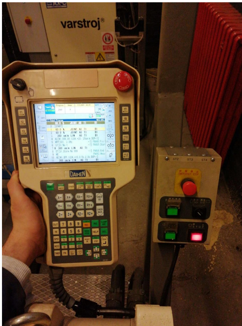
Slika 19. Privjesak za učenje i kontroler AX - C
