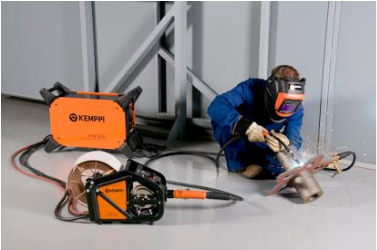
Slika 2. PoluautomatskoMIG/ MAG zavarivanje [10]
