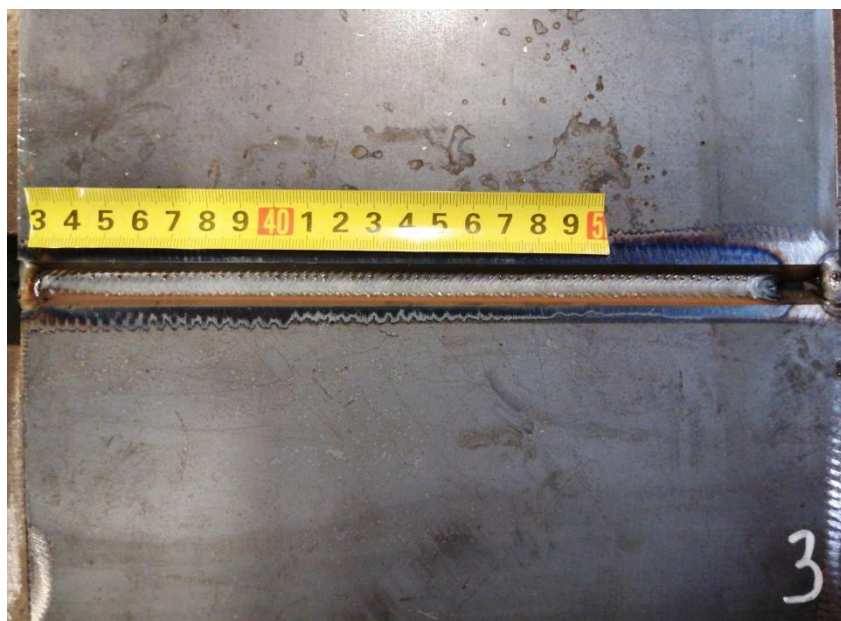
Slika 28. Treći korijenski zavar
