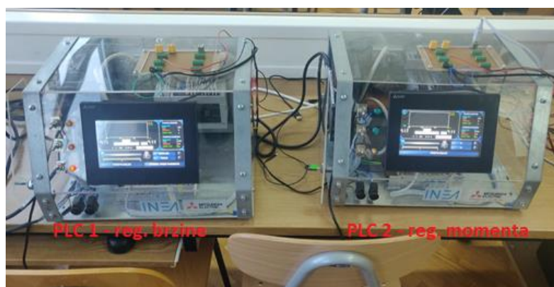
Slika 36. PLC makete sa servo pojačalima i HMI sučeljem
