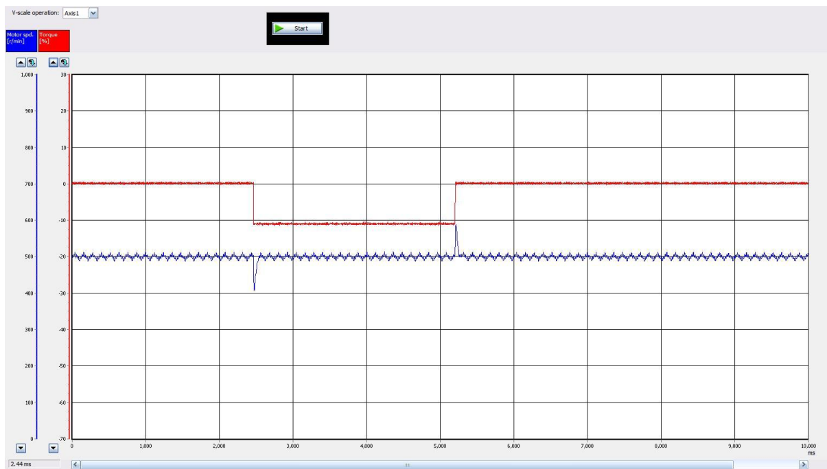
Slika 55. Mjerenje odziva pri 10% nazivnog momenta i 500 o/min
