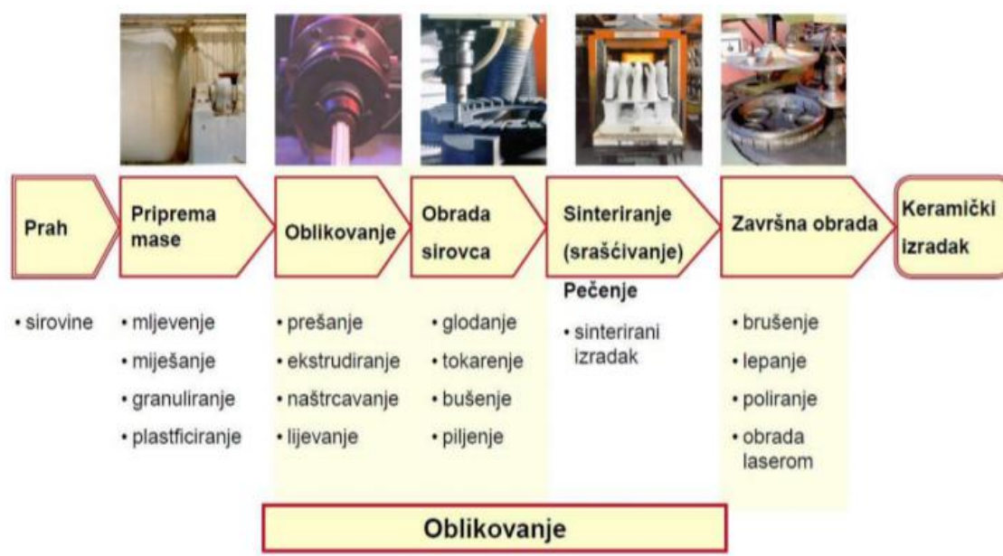
Slika 13. Proces proizvodnje keramike [28]
