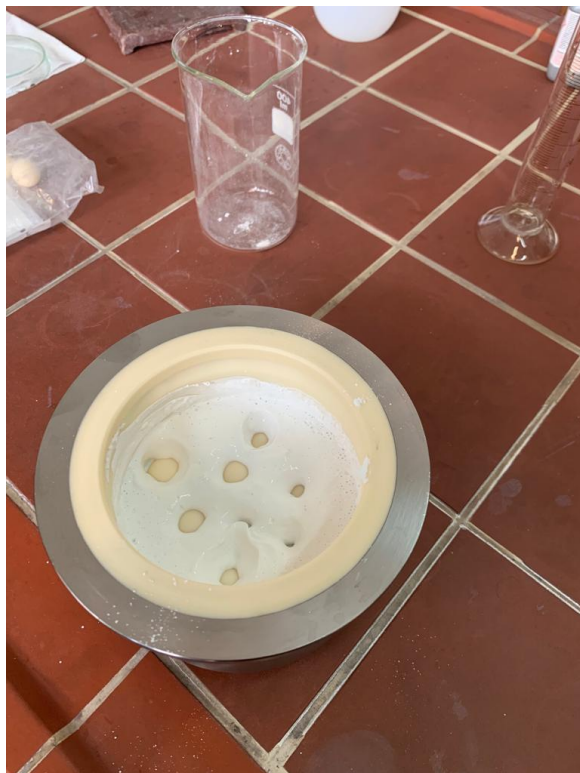
Slika 23. Posuda za homogenizaciju unutar koje je suspenzija te 8 keramičkih kuglica promjera 10 mm
