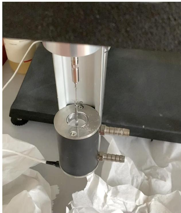
Slika 28. Cilindar sa suspenzijom i vretenom
