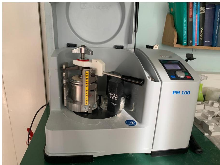
Slika 24. Planetarni kuglični mlin Retsch PM 100
