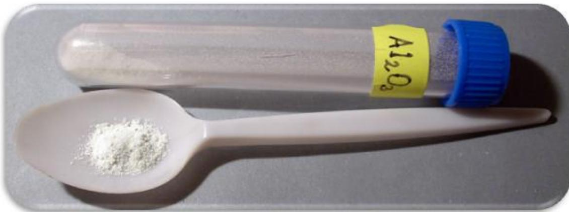
*Slika 2.- Aluminijev oksid u praškastom obliku [11]*
