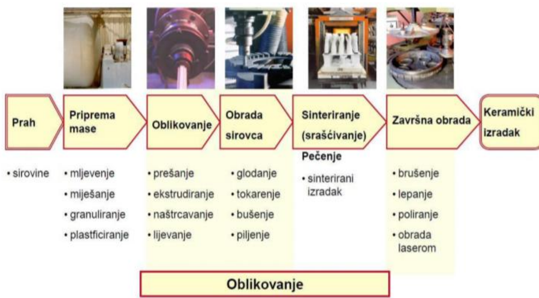
Slika 13. Proces proizvodnje keramike [28]
