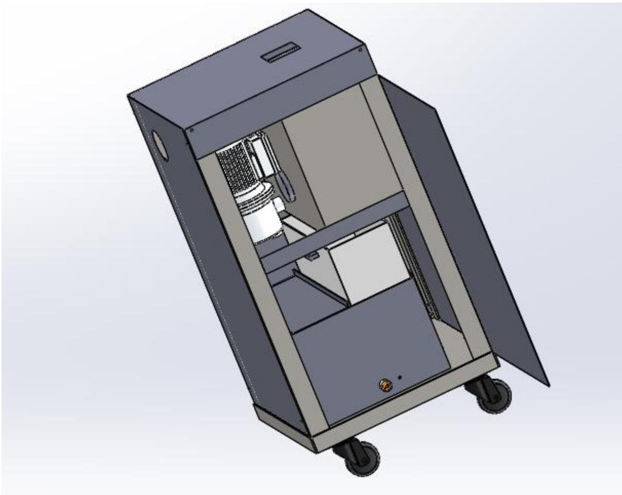
**Slika 17. Sklop perača zraka**
