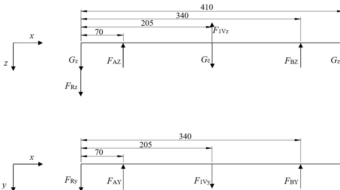
Slika 38. Sile u horizontalnoj i vertikalnoj ravnini za slučaj II.
