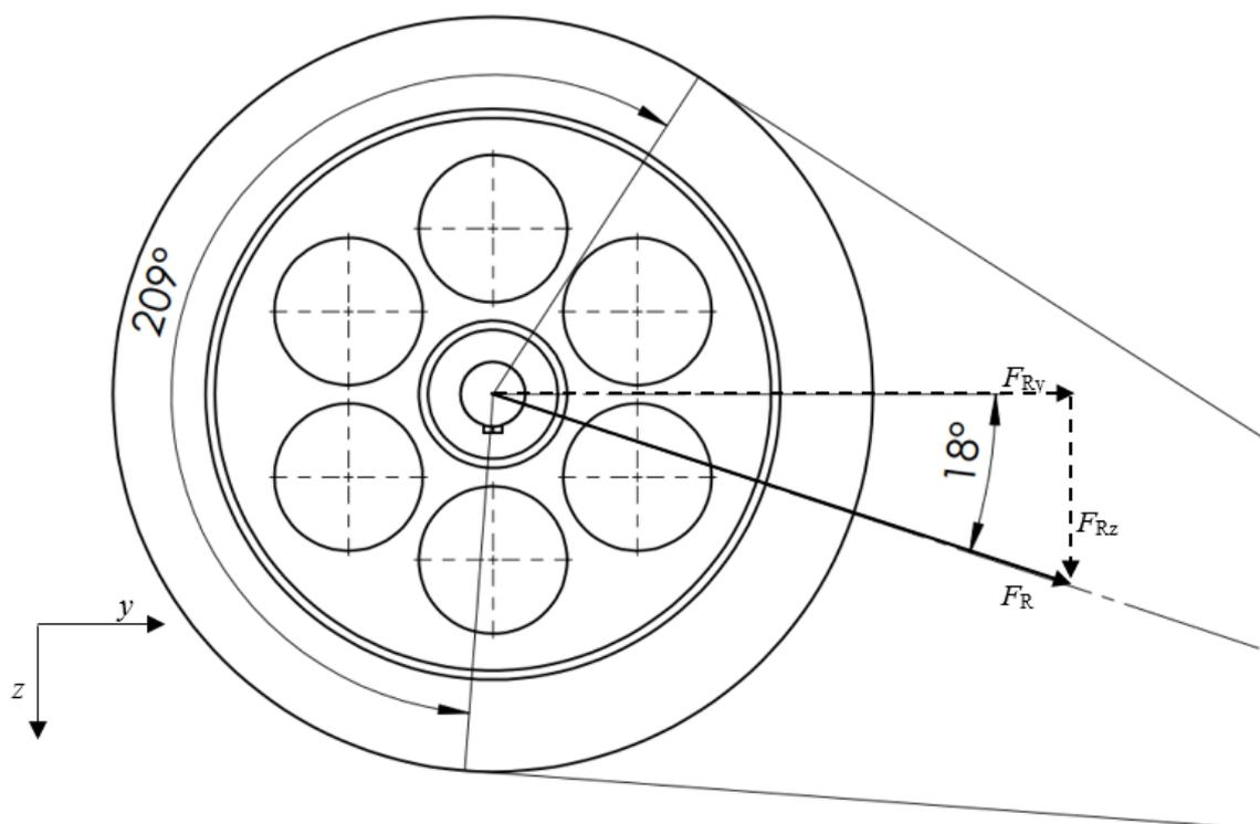
**Slika 31. Rezultantna sila remena i komponente**
