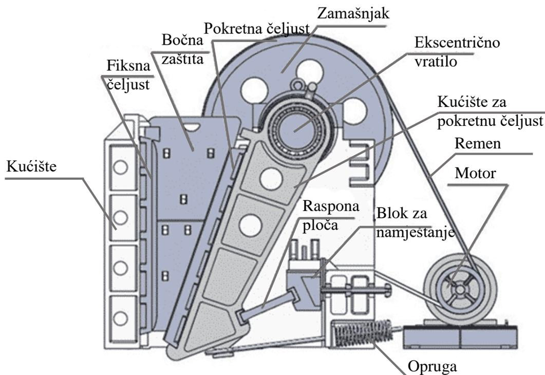
Slika 6. Dijelovi drobilice
