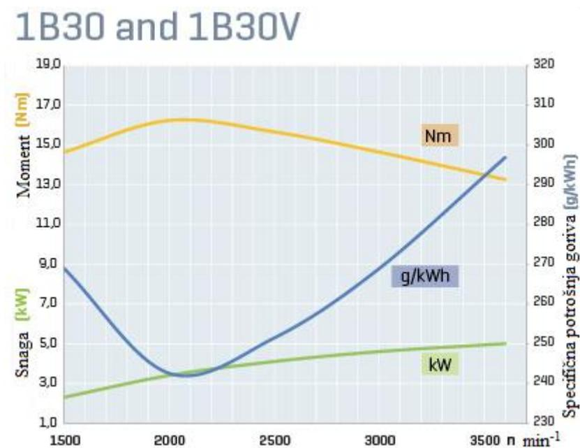
Slika 28. Karakteristike motora
