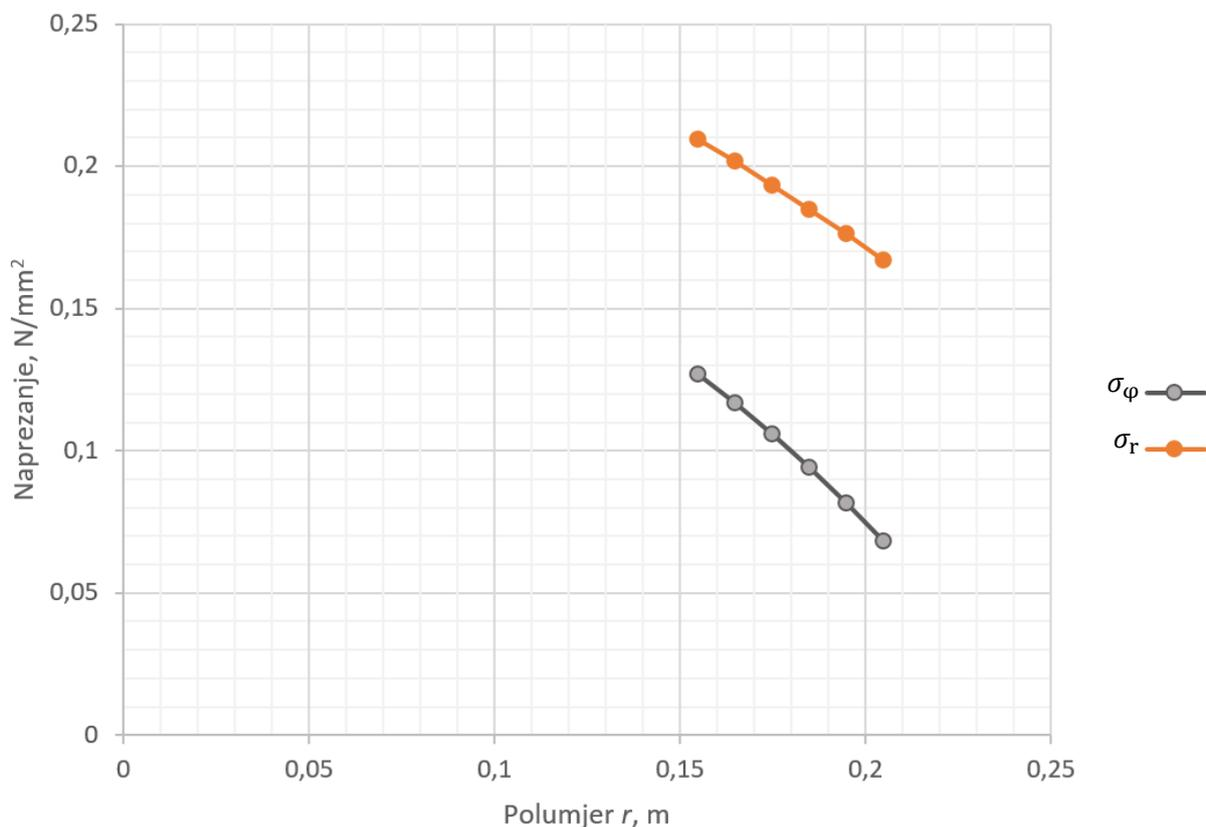
**Slika 27. Iznos komponenti naprezanja u ovisnosti o polumjeru  $r$**
