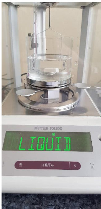
Slika 29. Mjerenje mase uzorka u mediju
