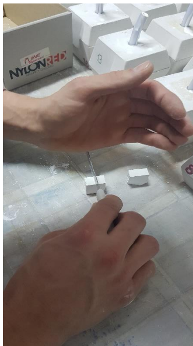
Slika 21. Rezanje uzoraka u zelenom stanju
