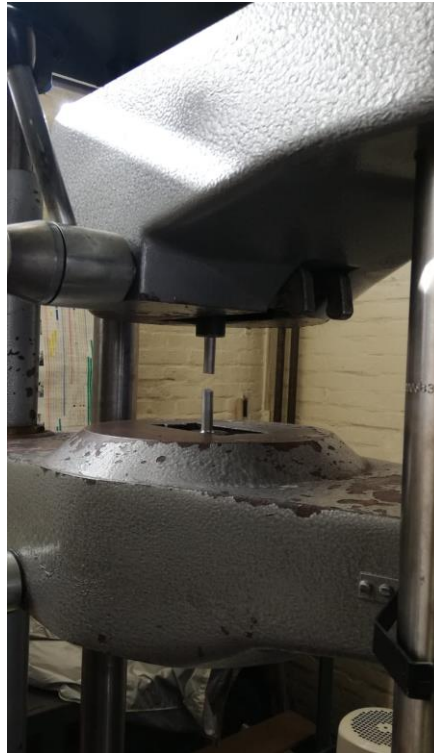
Slika 22. Epruveta stegnuta u čeljusti kidalice
