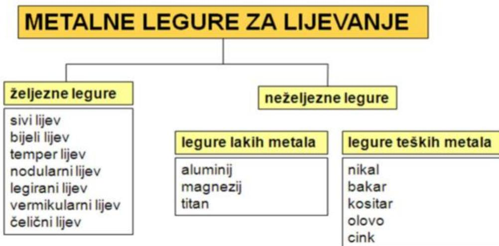
Slika 8. Podjela metalnih legura za lijevanje [2]
