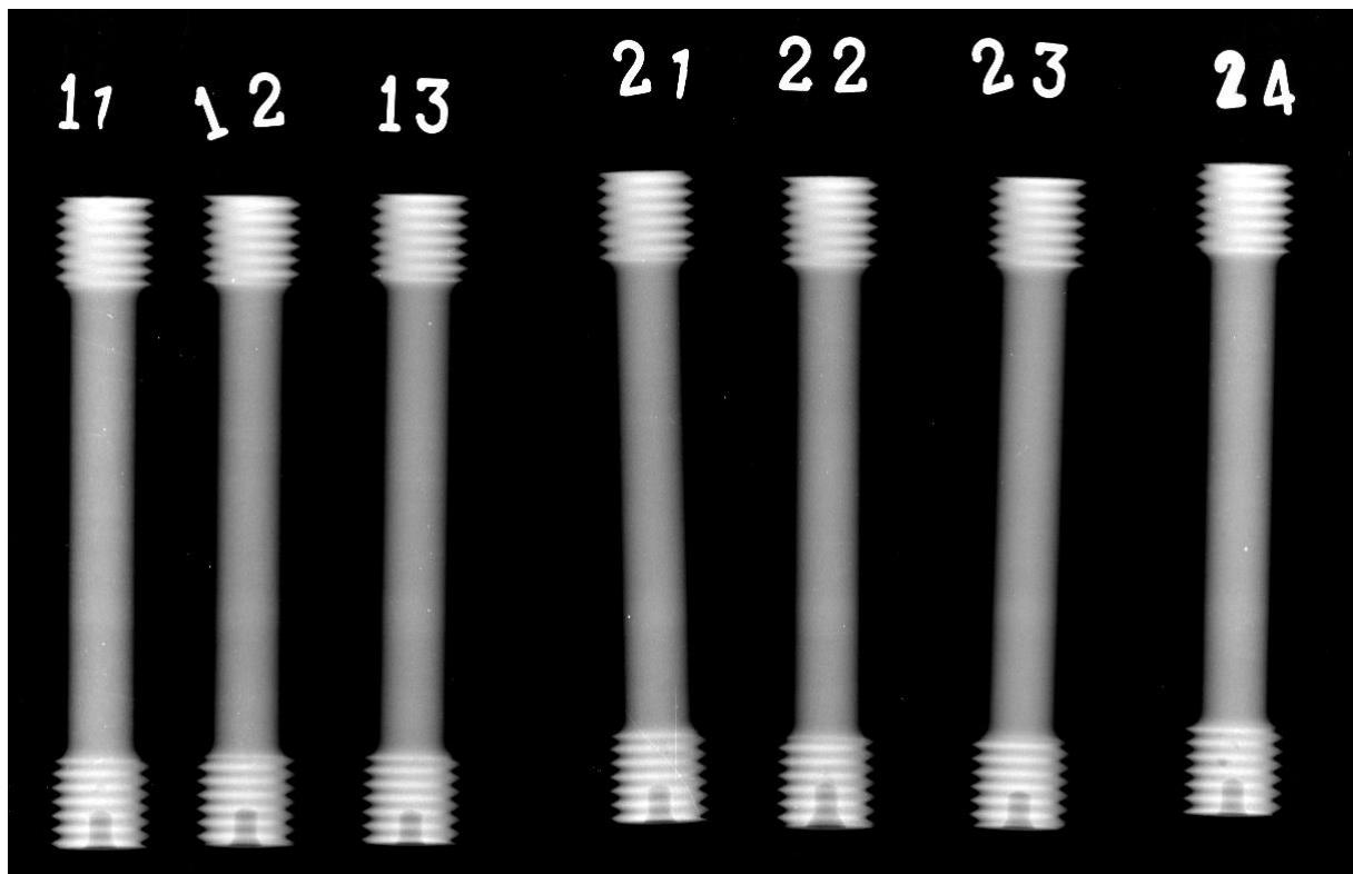
Slika 29. Radiogram epruveta za statičko vlačno ispitivanje
