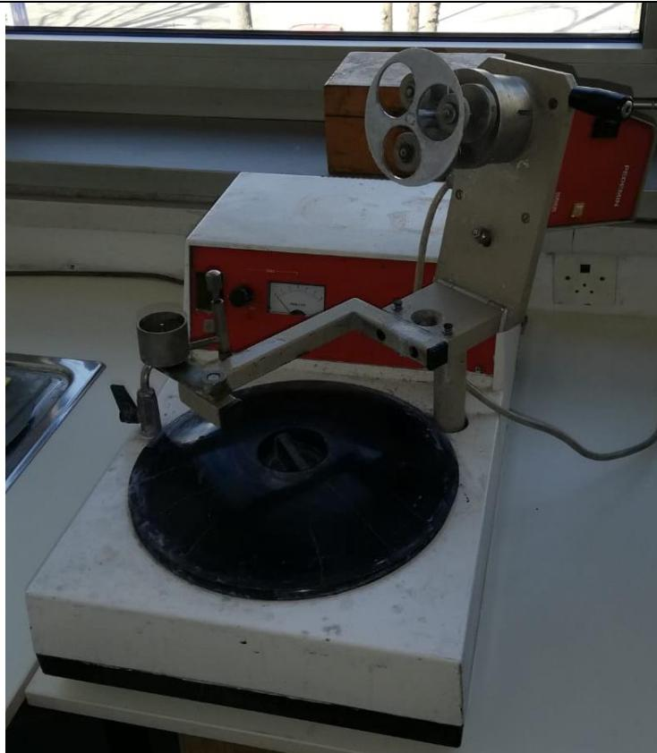
Slika 24. Uređaj za poliranje „Struers DAP – V“
