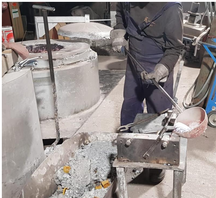
Slika 12. Prikaz lijevanja u kokilu
