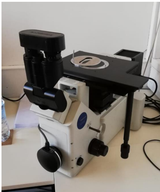
Slika 26. Svjetlosni mikroskop „Olympus GX 51“
