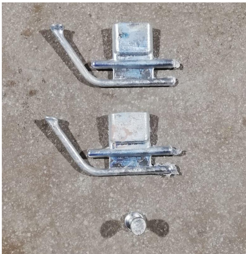
Slika 13. Odlivene epruvete i uzorak za ispitivanje kemijskog sastava
