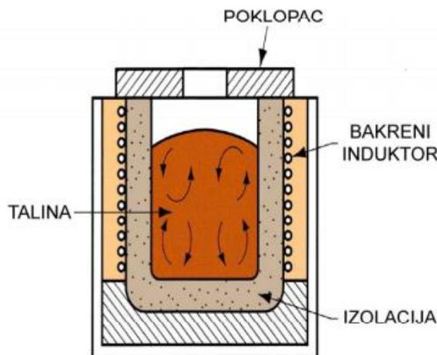
Slika 5. Indukcijska peć [7]
