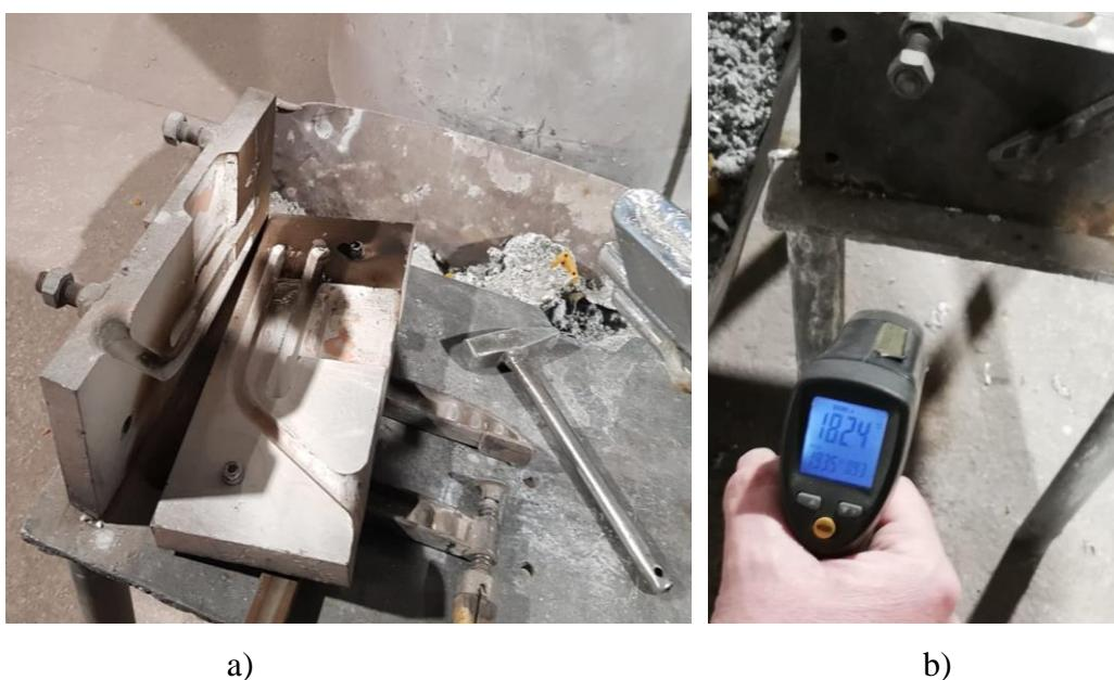
Slika 11. a) otvorena kokila, b) mjerjenje temperature kokile
