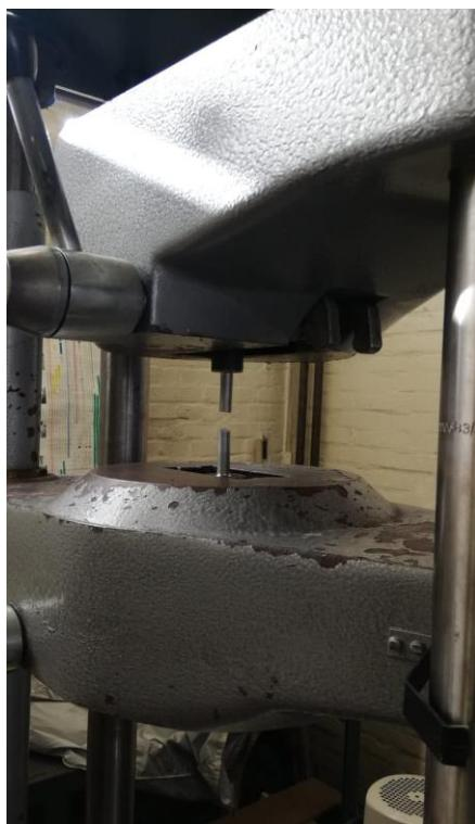
Slika 22. Epruveta stegnuta u čeljusti kidalice
