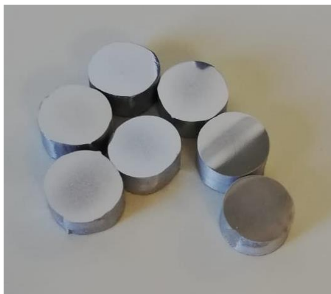
Slika 25. Uzorci za metalografsko ispitivanje
