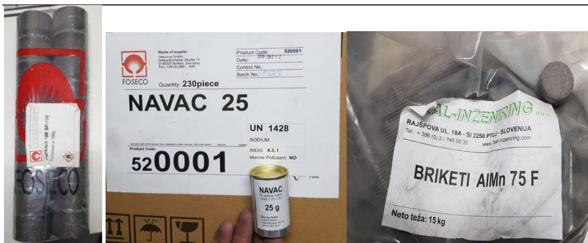
Slika 16. Dodaci za obradu taljevine a) pakiranje AlTiB predlegure, b) pakiranje čistog natrija, c) briketi AIMn
