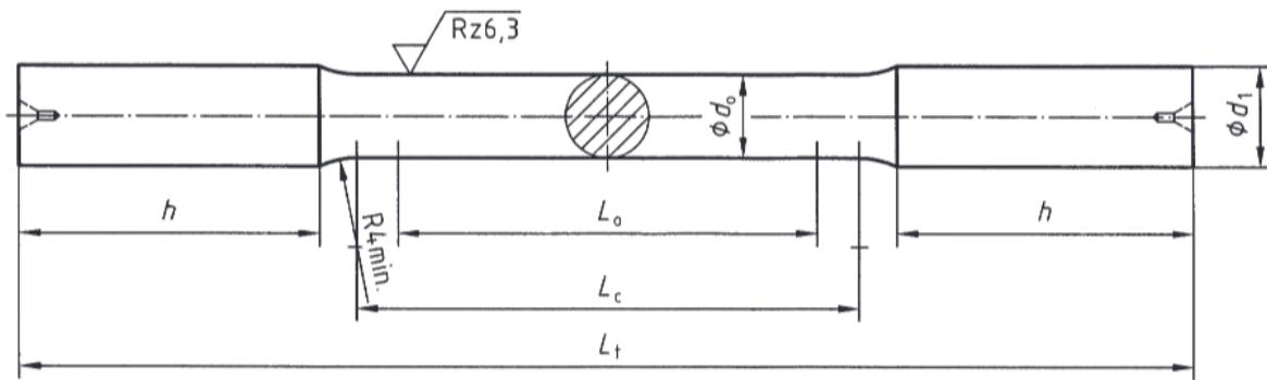
Slika 19. Dimenzije epruvete [19]
