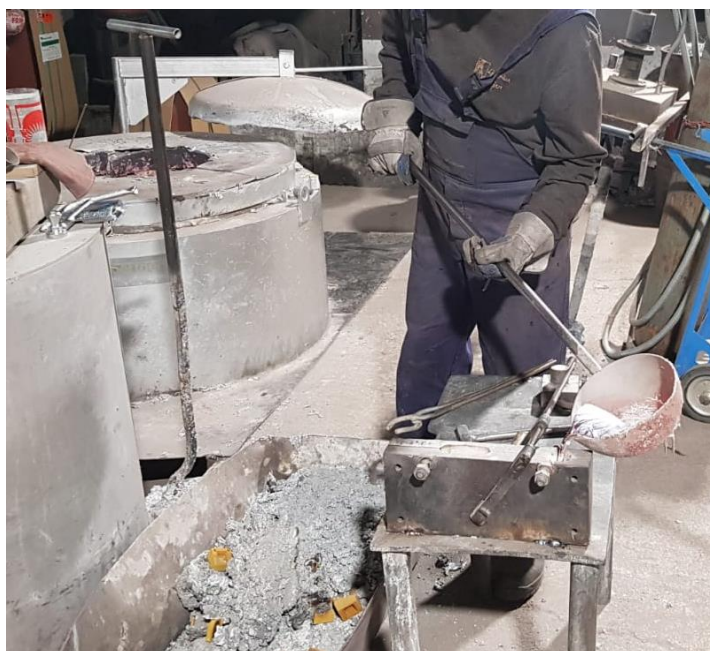
Slika 12. Prikaz lijevanja u kokilu
