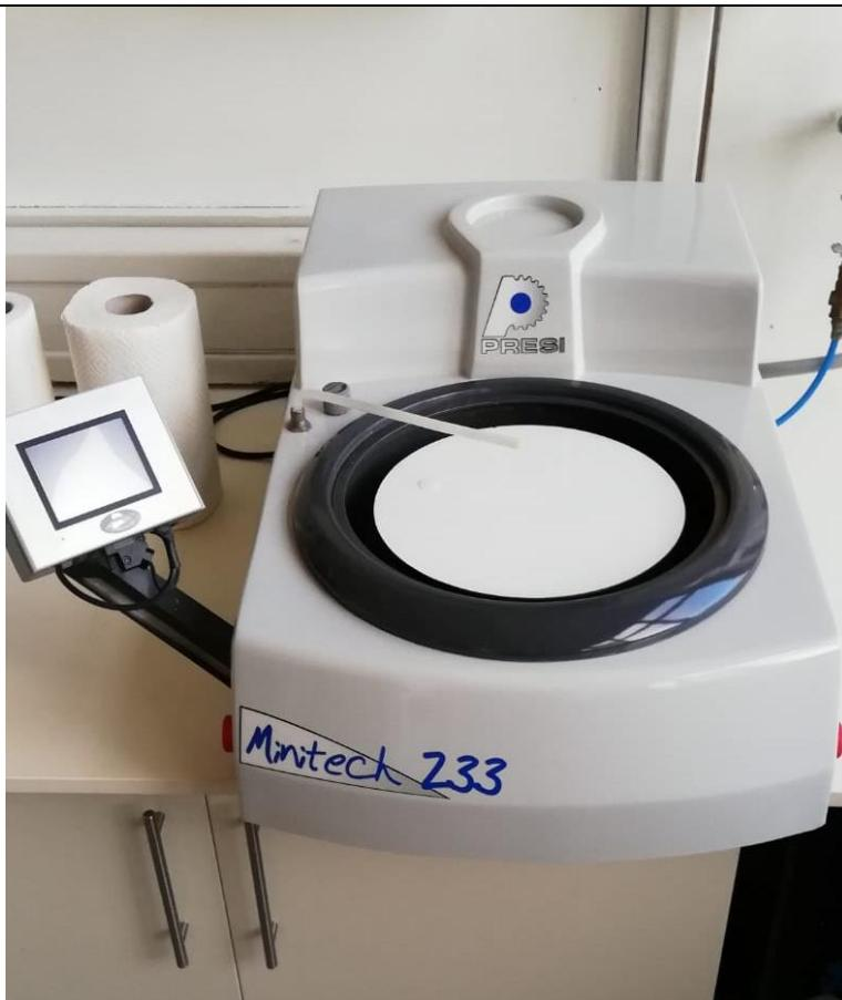
Slika 23. Uređaj za brušenje Minitech 233
