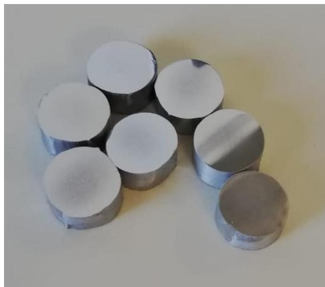
Slika 25. Uzorci za metalografsko ispitivanje
