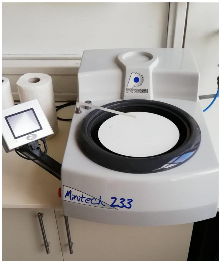
Slika 23. Uređaj za brušenje Minitech 233
