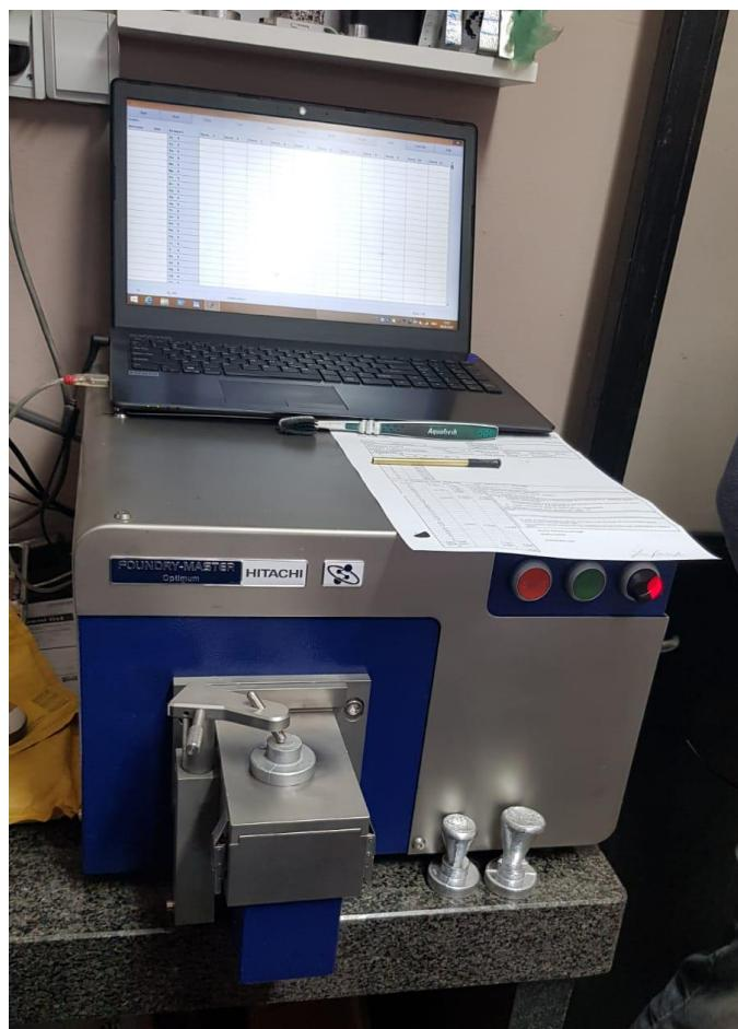
Slika 18. Spektrometar za mjerjenje kemijskog sastava
