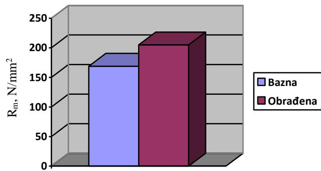
Slika 30. Grafički prikaz prosječne vrijednosti vlačne čvrstoće ( $R_m$ ) bazne i obrađene legure
