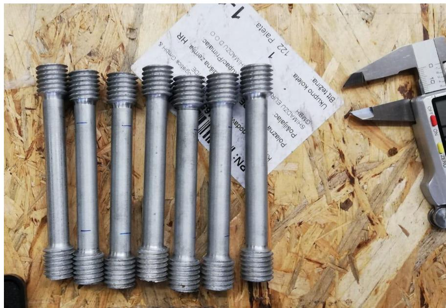
Slika 20. Epruvete za statičko vlačno ispitivanje
