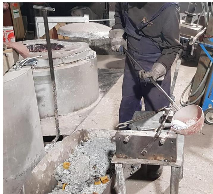
Slika 12. Prikaz lijevanja u kokilu
