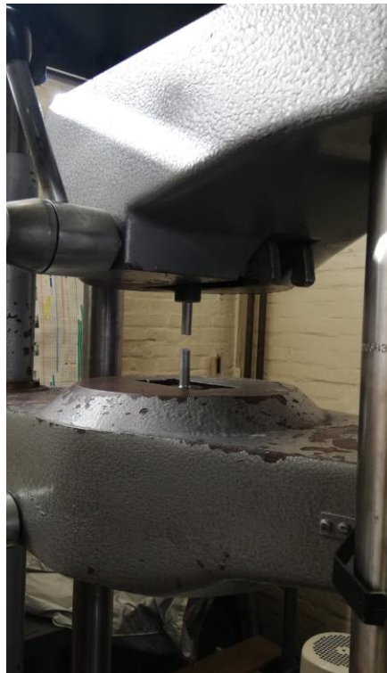
Slika 22. Epruveta stegnuta u čeljusti kidalice
