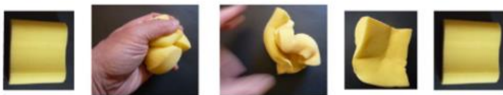
Slika 5.2. Viskoelastičnost memorijske pjene [6]
