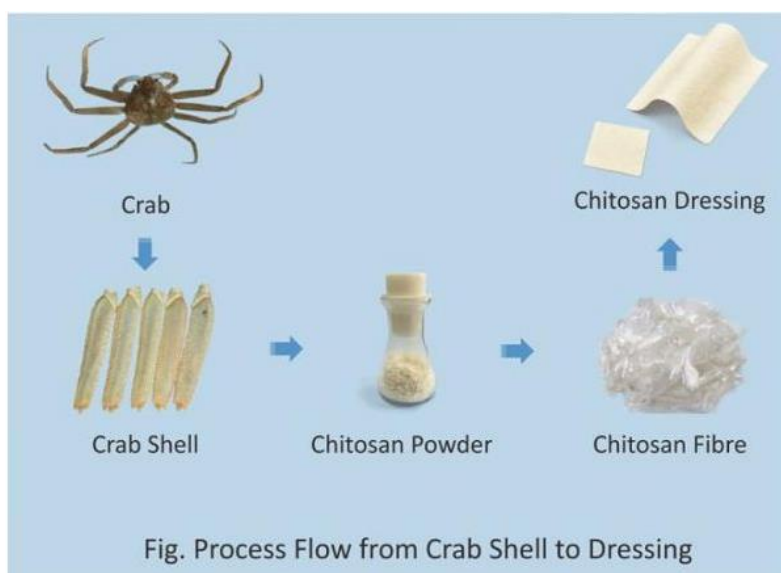
Slika 3.3. Tok procesa proizvodnje zavoja od hitozana [11]
