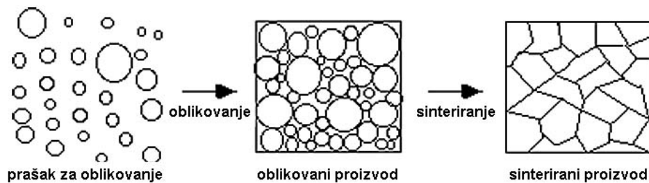
Slika 13 Tijek proizvodnje od praha do sinteriranog sirovca (proces sinteriranja) [3]
