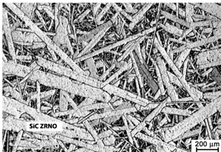
Slika 5 Mikrostruktura grubozrnatog SSiC [1]
