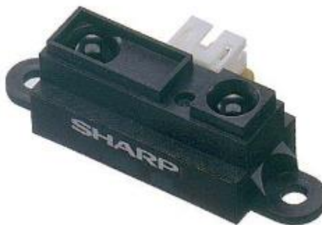
Slika 15. Sharp IR daljinomjer[1]
