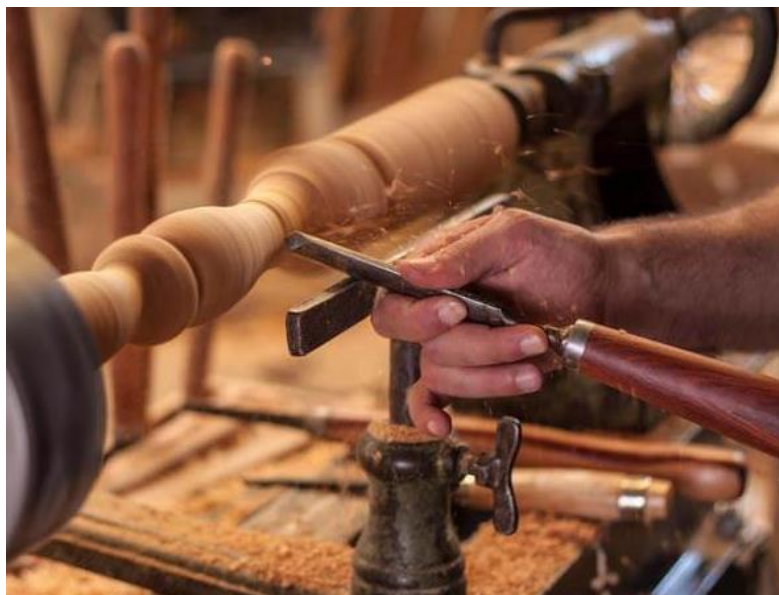
Slika 3. Obrada drva na tokarskom stroju
