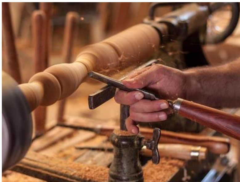
Slika 3. Obrada drva na tokarskom stroju
