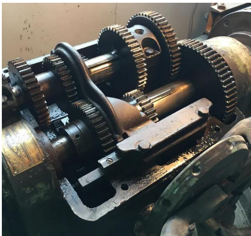
Slika 8. Zupčanički prijenosnik na tokarskom stroju
