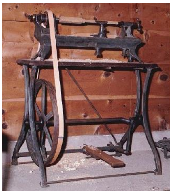
Slika 1. „Wilkinson“ tokarski stroj pokretan nogom, 19. st.
