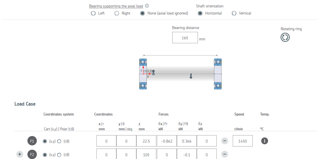
Slika 27. Opterećenje vratila V_1 zadano u [7]
