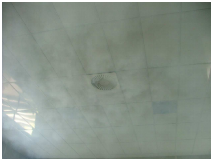
Slika 28. Eksperimentalno mjerenje, difuzor sa prstenom [2]
