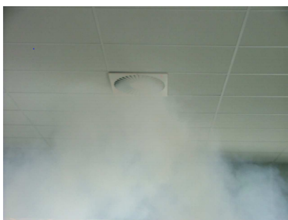
Slika 24. Eksperimentalno mjerenje, difuzor bez prstena [2]
