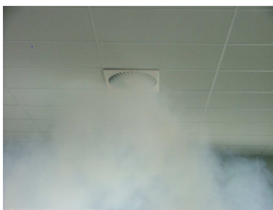
Slika 24. Eksperimentalno mjerenje, difuzor bez prstena [2]
