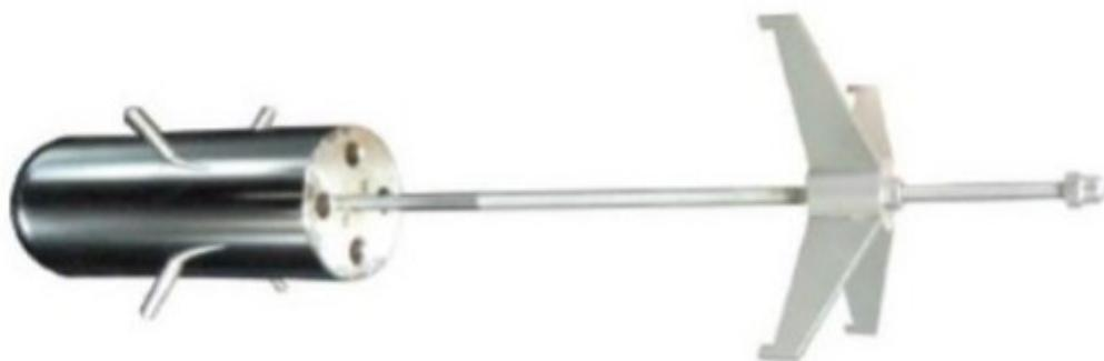
Slika 5 Izotermalni blok za umjeravanje termometara
