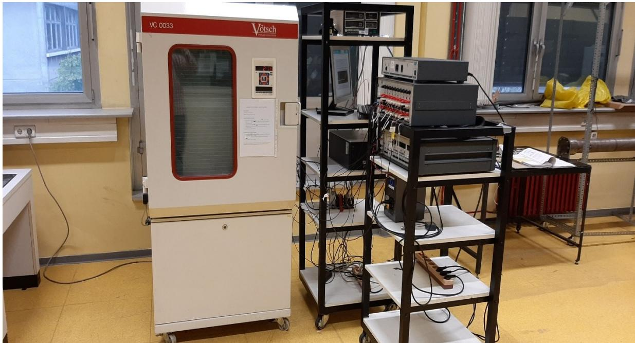
Slika 8 Oprema korištena za ispitivanje karakteristika higrostatirane komore
