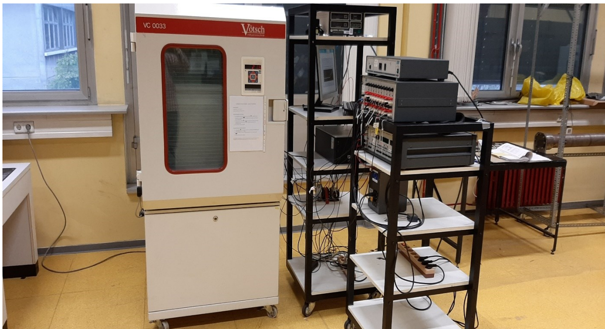
Slika 8 Oprema korištena za ispitivanje karakteristika higrostatirane komore
