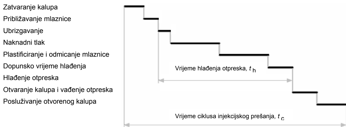
Slika 2.2. Faze injekcijskog prešanja plastomera [4]
