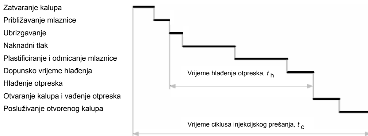
Slika 2.2. Faze injekcijskog prešanja plastomera [4]
