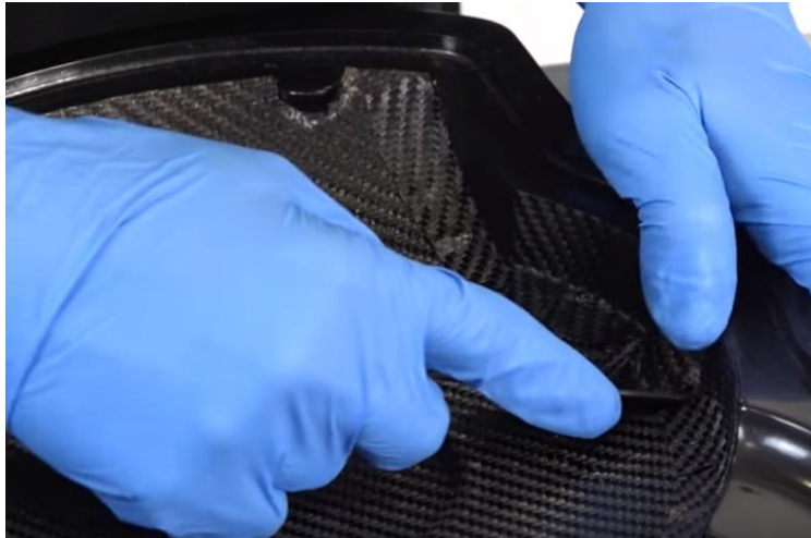
Slika 5.7 Ulagivanje kompozitnog materijala u kalup [14]
