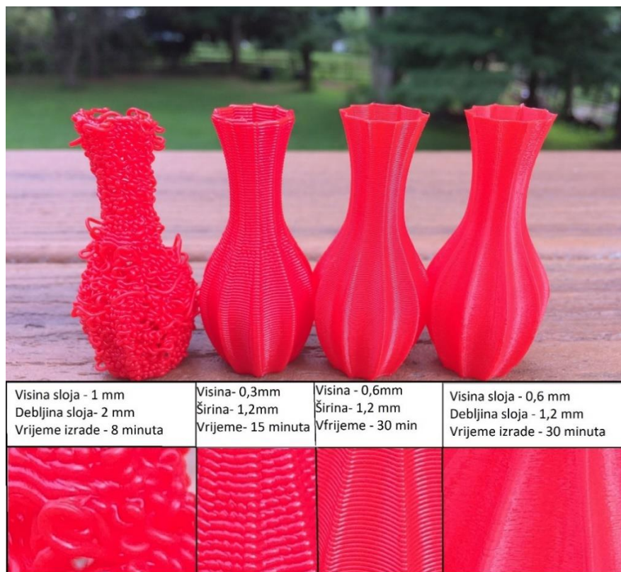
Slika 2.1. Kvaliteta proizvoda i vrijeme izrade u odnosu na visinu sloja i broj kontura [2]
