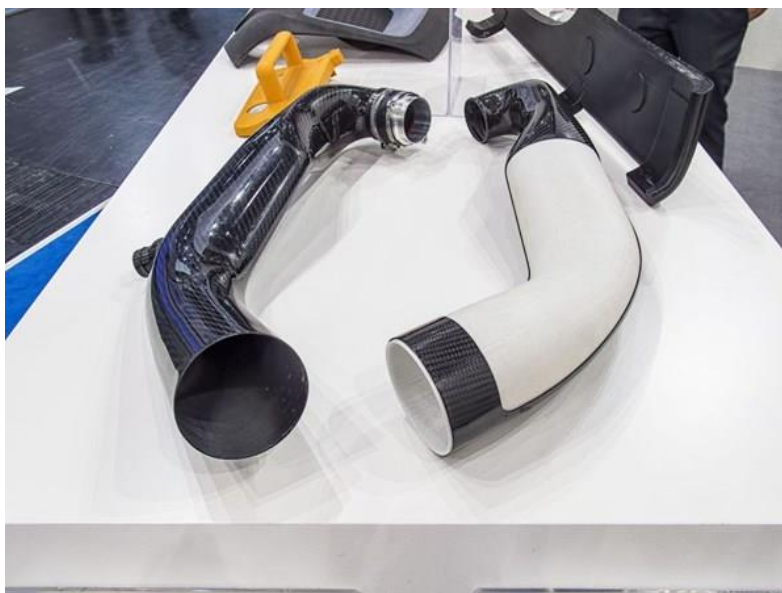
Slika 6.3 Cijevi ispušnog sustava izrađene pomoću taljivih jezgri iz kompozitnog materijala epoksidna smola/ugljična vlakna [19]
