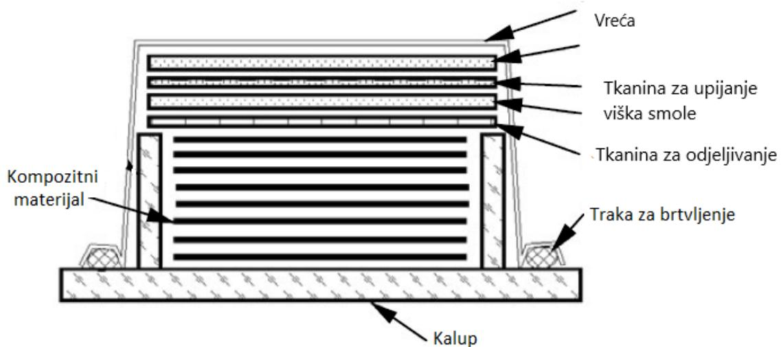
Slika 5.9 Shematski prikaz postupka podtlačnog oblikovanja [12]
