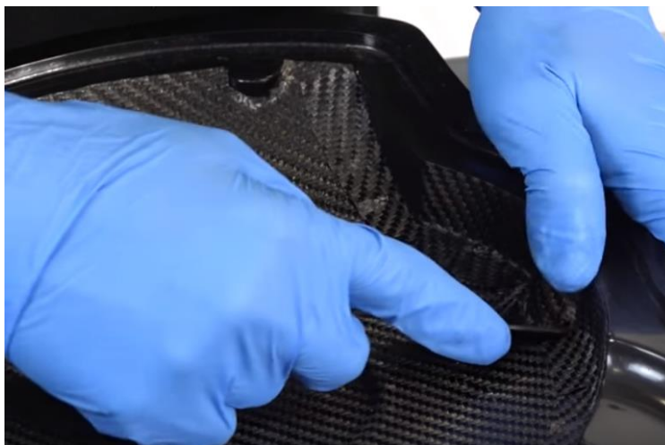
Slika 5.7 Ulagivanje kompozitnog materijala u kalup [14]
