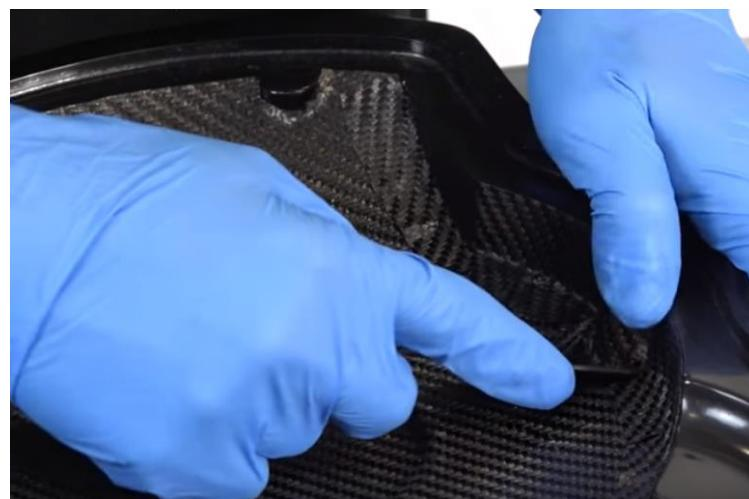
Slika 5.7 Ulagivanje kompozitnog materijala u kalup [14]
