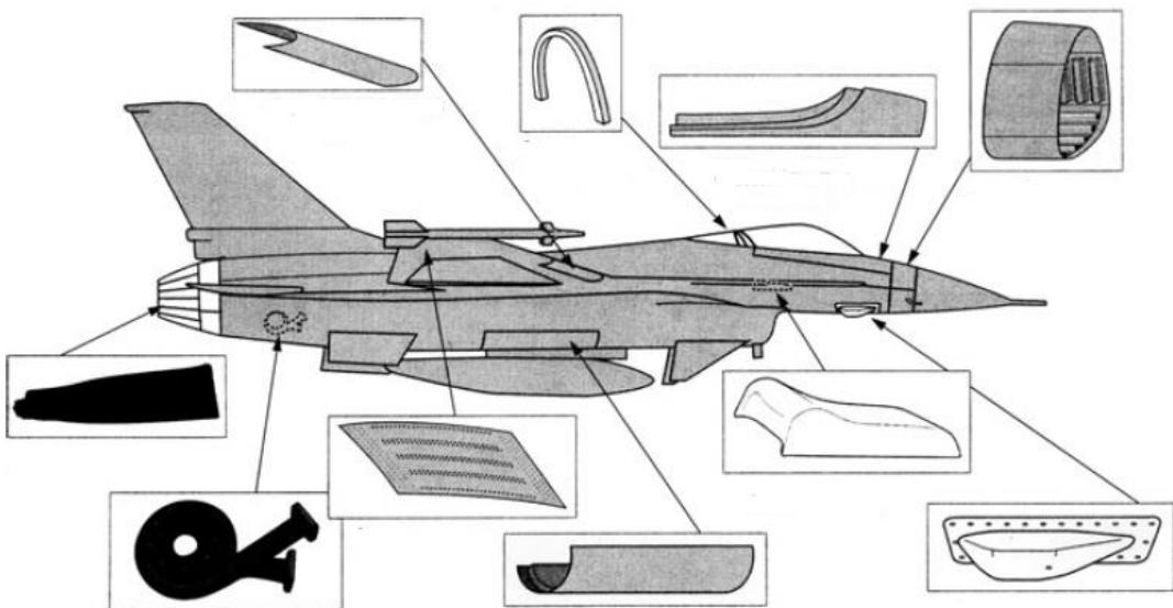
Slika 5.5 Razni kompozitni tvorevine korišteni u konstruiranju borbenog zrakoplova
