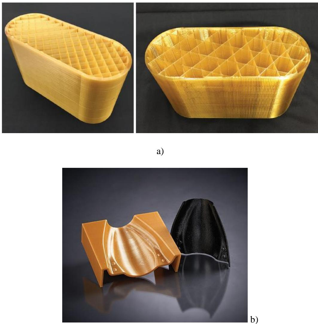
Slika 6.2 Kalupi načinjeni postupkom FDM: a) Kalup sa šupljom unutrašnjosti; b) školjkasti kalup [13]
