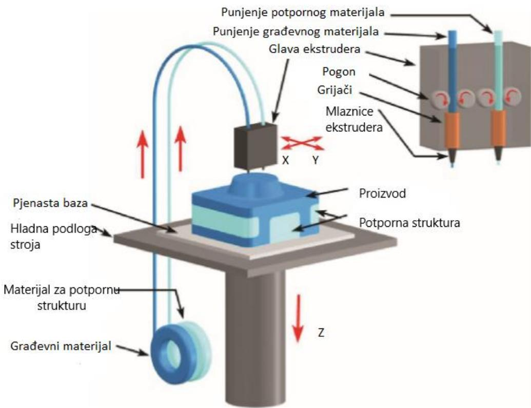
Slika 3.3. Oprema potrebna za FDM postupak [5]
