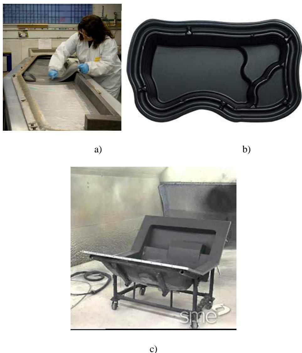
Slika 5.11 a) postupak ručnog laminiranja; b) proizvod izrađen postupkom ručnog laminiranja; c) kalup za ručno laminiranje
