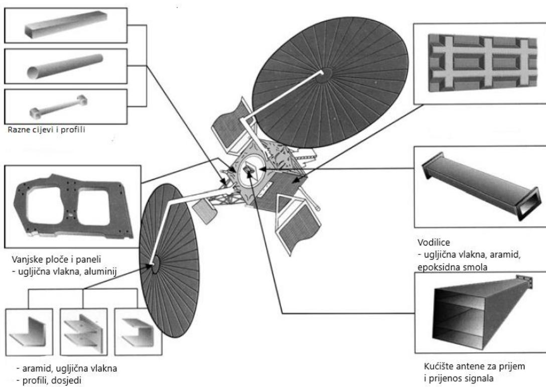
Slika 5.6 Razni dijelovi satelita načinjeni od kompozitnih materijala [12]
