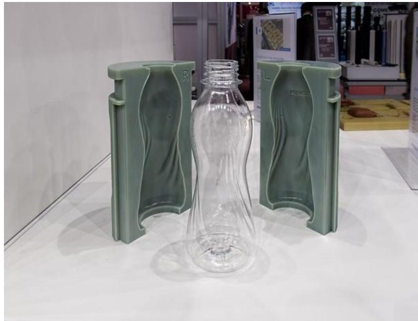
Slika 7.5 Kalup za injekcijsko puhanje, izrađen 3D ispisom iz digitalnog ABS-a [19]
