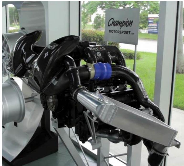
Slika 6.4 Cijevi ispušnog sustava u motoru *Porsche* vozila [17]
