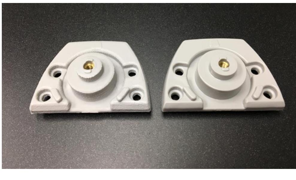
Slika 7.1. Usporedba obradaka izrađenih u kalupu konstruiranom klasičnim postupcima i u kalupu izrađenom 3D printerom [20]
