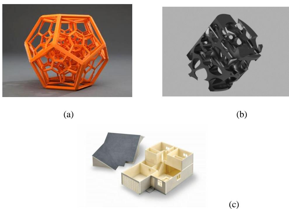
Slika 3.1. Primjeri različitih složenih geometrija izrađenih AM postupcima (a,b,c) [4]
