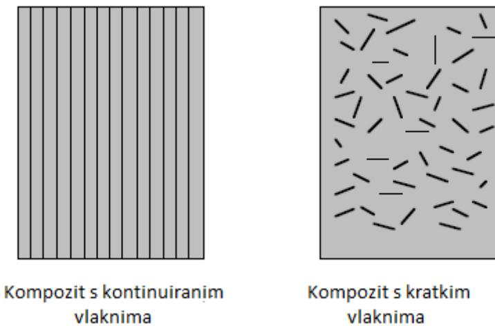
Slika 5.2 Vrsta kompozitnog materijala prema orijentaciji vlakana [12]
