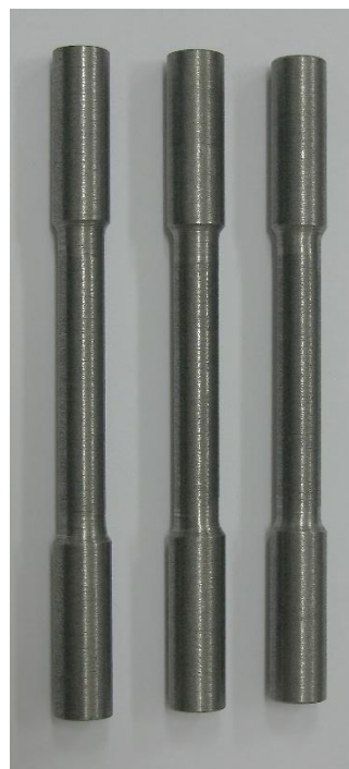
Slika 18. Ispitni uzorci a) iz konstrukcijskog čelika i b) iz nodularnog lijeva
