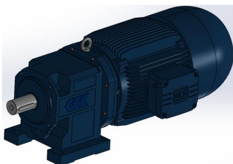
Slika 93. 3D model elektromotora s reduktorom i kočnicom
