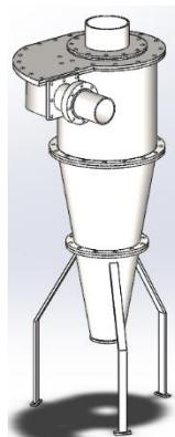
**Slika 70. Uvećani prikaz 3D modela ciklonskog separatora**
