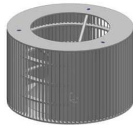
**Slika 55. Cilindrični rotor**
