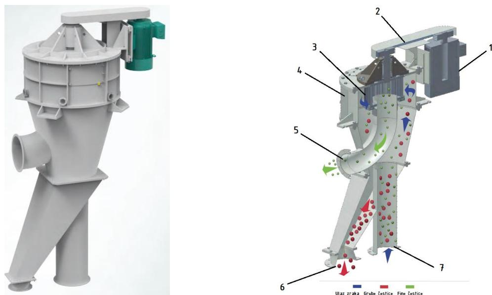
Slika 52. Zračni klasifikator Scirocco
