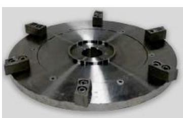
**Slika 13. Rotor s čekićima**
