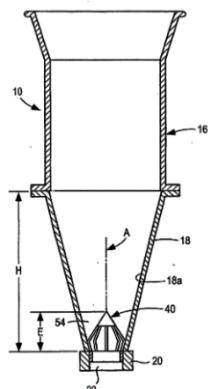
**Slika 40. Sustav za ostvarivanje jednolikog toka materijala u presjeku**
