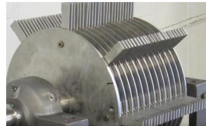
**Slika 21. Rotor s zglobno vezanim čekićima (veće površine)**
