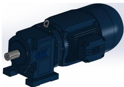
**Slika 93. 3D model elektromotora s reduktorom i kočnicom**
