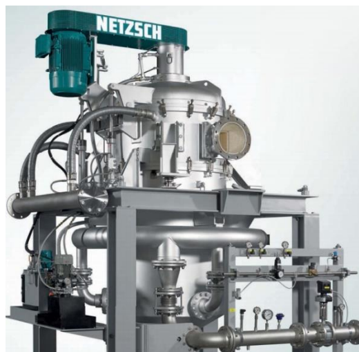
Slika 35. Stroj za usitnjavanje materijala primjenom struje zraka – model CGS 16
