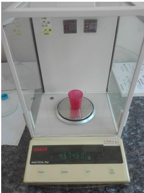
Slika 21. Uređaj za mjerenje mase (digitalna vaga)
