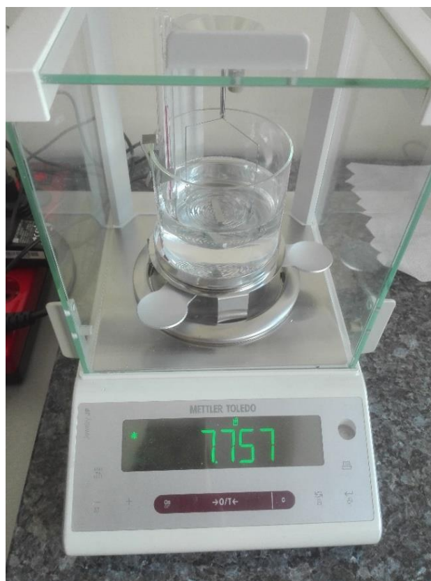
Slika 19. Uređaj za mjerenje gustoće
