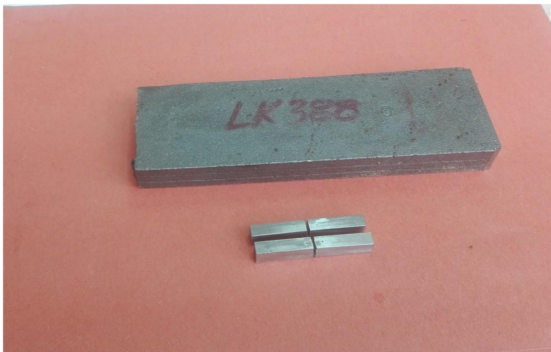
Slika 17. Izrezani uzorci austenitnog nehrđajućeg čeličnog lijeva
