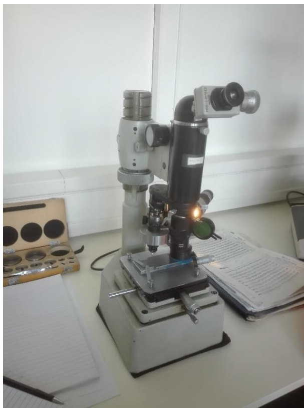
Slika 22. Uređaj za mjerenje tvrdoće
