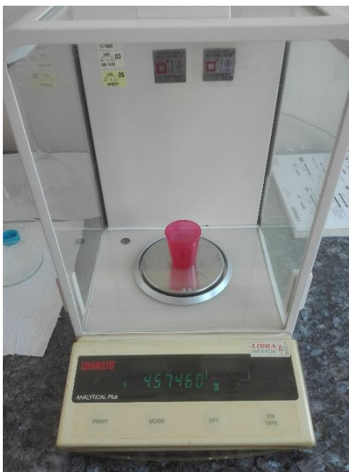
Slika 21. Uređaj za mjerenje mase (digitalna vaga)
