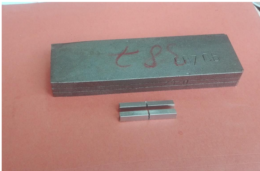
Slika 18. Izrezani uzorci dupleks nehrđajućeg čeličnog lijeva
