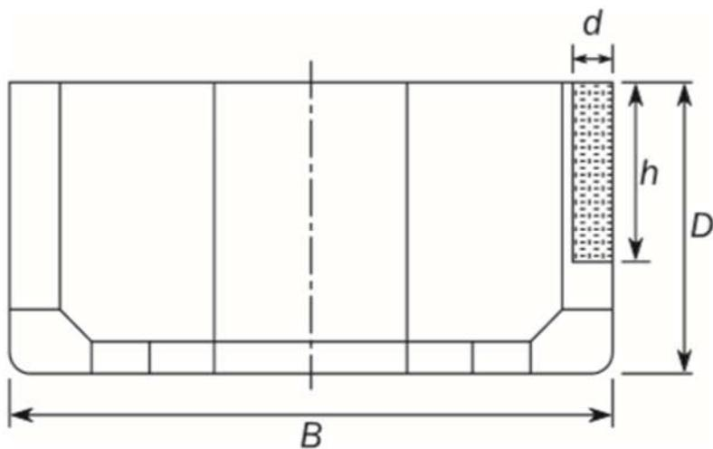
**Slika 6. Određivanje oštećenja u slučaju bočnog sudara [2]**
