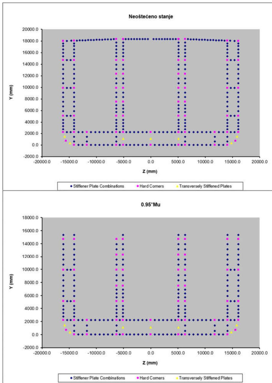
**Slika 13. Usporedba nekolabiranog i kolabiranog presjeka pri 0,95 Mu**
