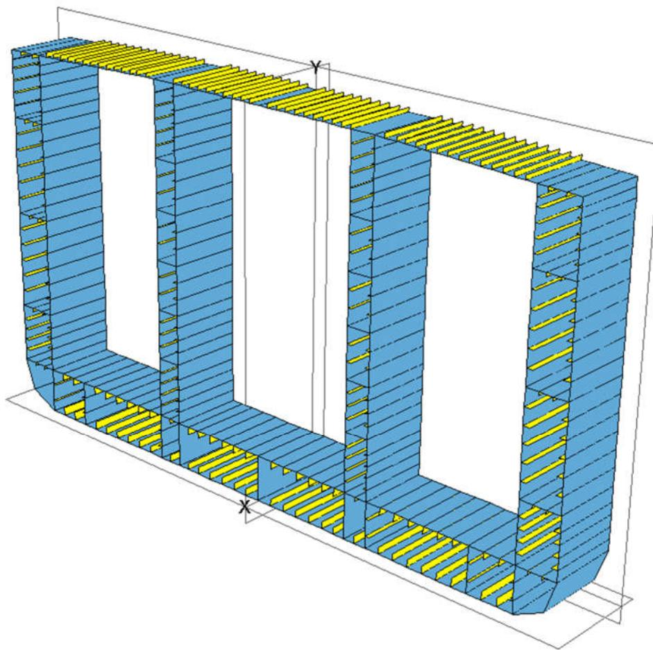
**Slika 8. Model glavnog rebra neoštećenog presjeka u Maestru**
