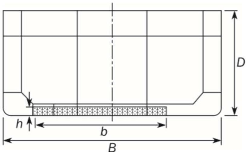
Slika 5. Određivanje oštećenja za slučaj nasukavanja broda [2]
