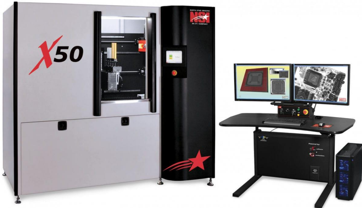
Slika 26. Industrijski tomograf X50+ (North Star Imaging)
