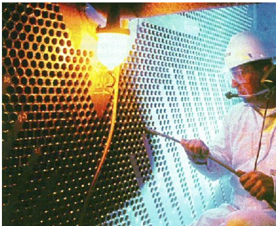
Slika 7. Ručno ispitivanje cijevne stijene [10]
