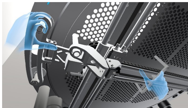
Slika 97. Inicijalno zatezanje konusnih matica
