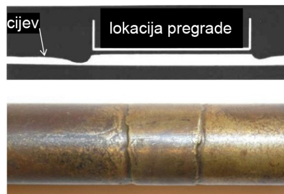
Slika 10. Oštećenja cijevi u neposrednoj blizini pregrade [12]
