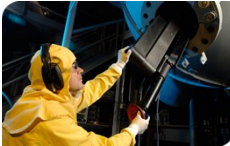
Slika 27. Unošenje Avera Rangera kroz otvor parogeneratora [19]
