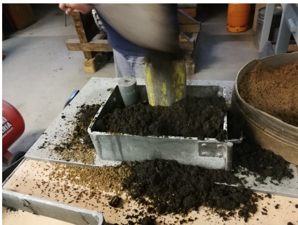
Slika 37. Dodavanje punidbene kalupne mješavine
