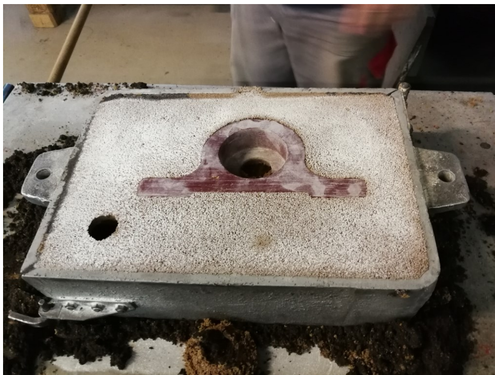
Slika 40. Model odljevka u gornjaku
