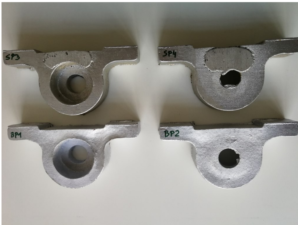
Slika 59. Odljevci bez uljevnog sustava
