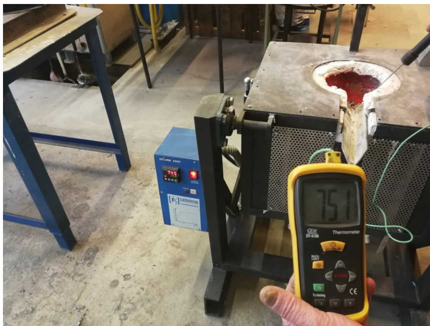
Slika 50. Temperatura taljevine u peći
