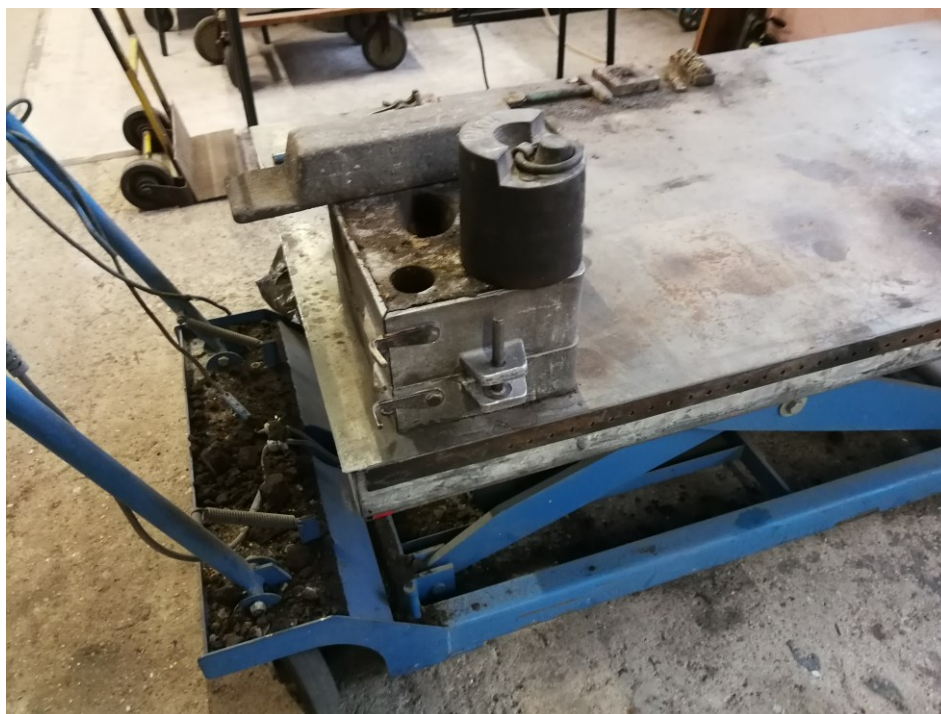
Slika 49. Gotov kalup spreman za lijevanje
