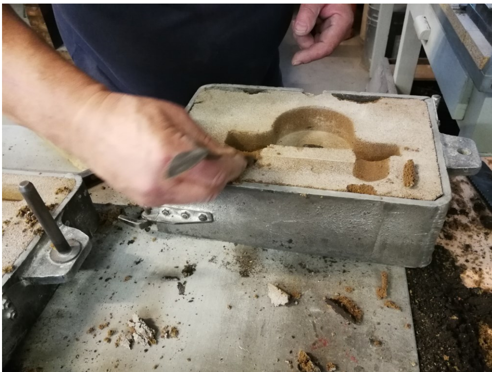
Slika 47. Oblikovanje ušća pomoću alata za obradu kalupne šupljine (lanceta)
