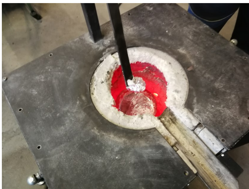
Slika 51. Uklanjanje troske sa površine taljevine
