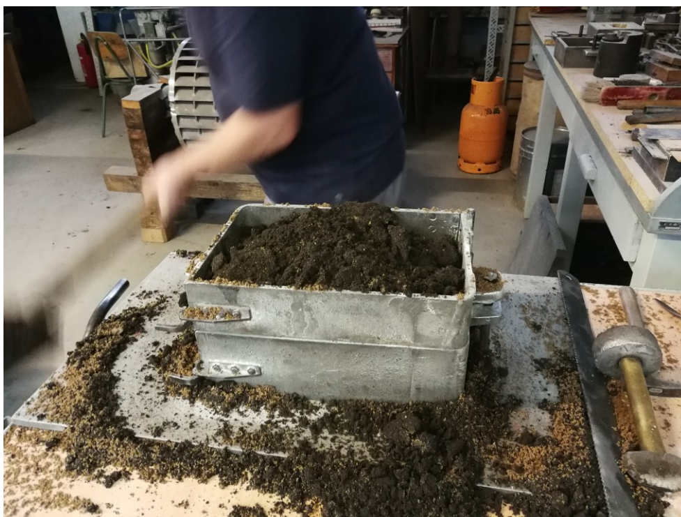
Slika 43. Dodavanje punidbene kalupne mješavine u donjak
