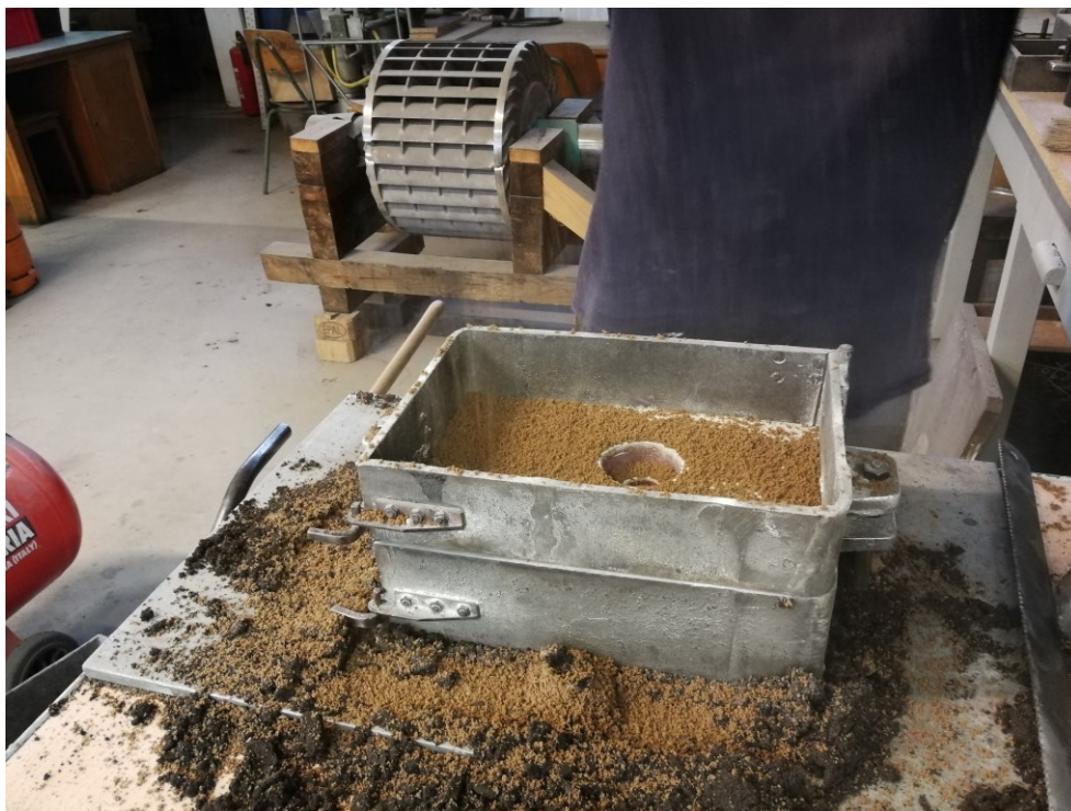
Slika 42. Nasipavanje donjaka modelnom kalupnom mješavinom
