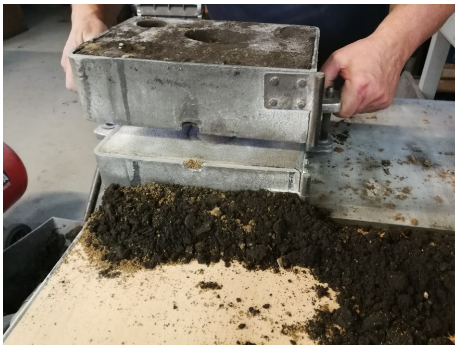
Slika 48. Zatvaranje kalupa prije lijevanja
