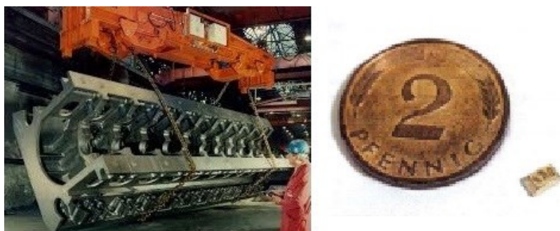
Slika 1. Blok velikog brodskog dizel motora mase 92,6 t i broj za kodiranje mase 0,08 g, oboje proizvedeni tehnologijom lijevanja. [2]
