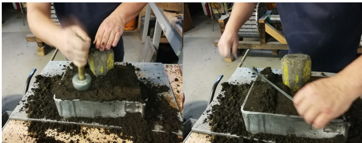
Slika 38. Sabijanje i poravnavanje kalupne mješavine
