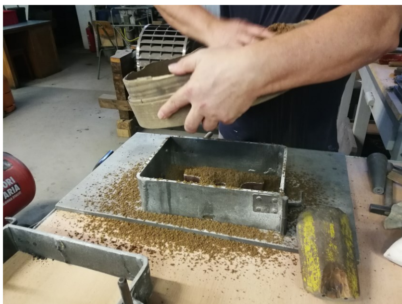
Slika 35. Nasipavanje modelnom kalupnom mješavinom
