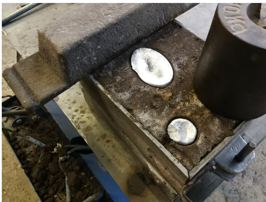
Slika 53. Hlađenje i skrućivanje odljevka
