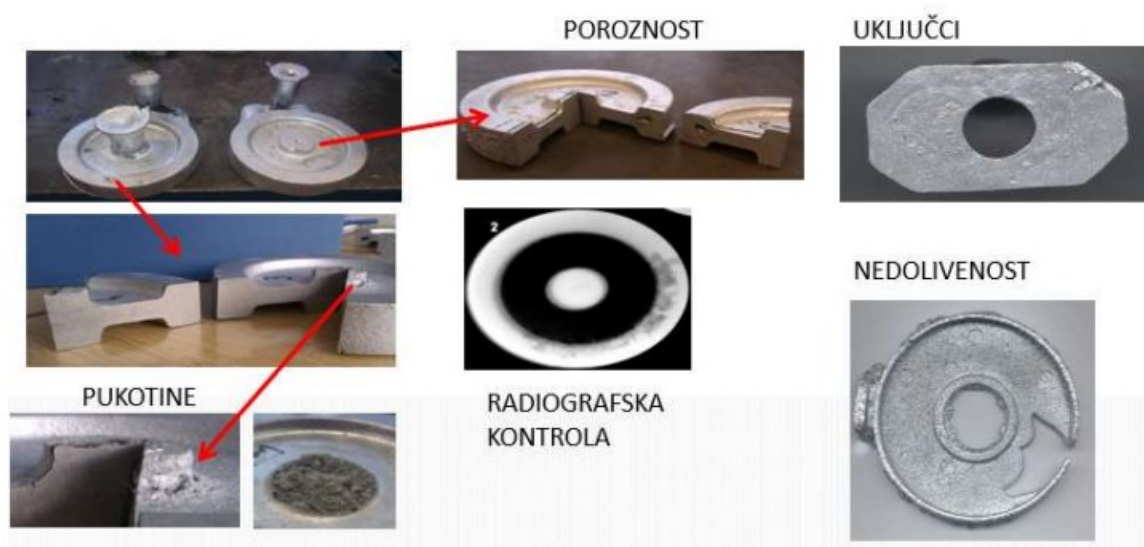
Slika 2. Osnovne greške na odljencima [1]
