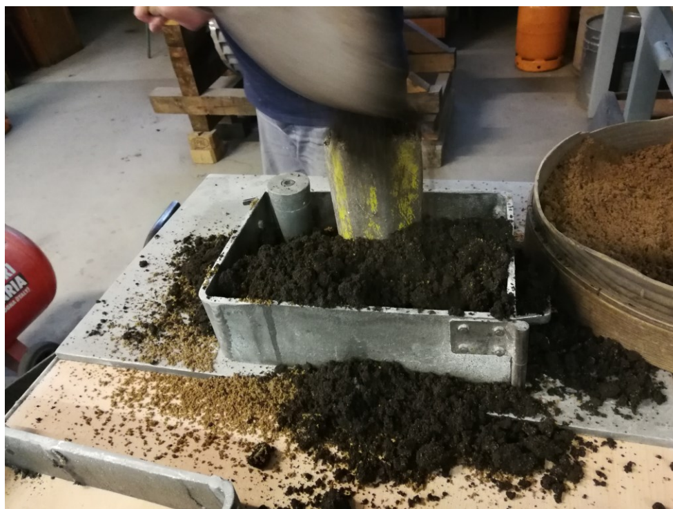
Slika 37. Dodavanje punidbene kalupne mješavine
