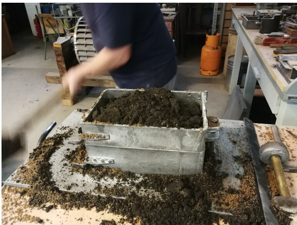
Slika 43. Dodavanje punidbene kalupne mješavine u donjak
