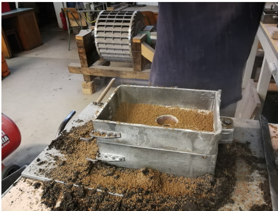
Slika 42. Nasipavanje donjaka modelnom kalupnom mješavinom
