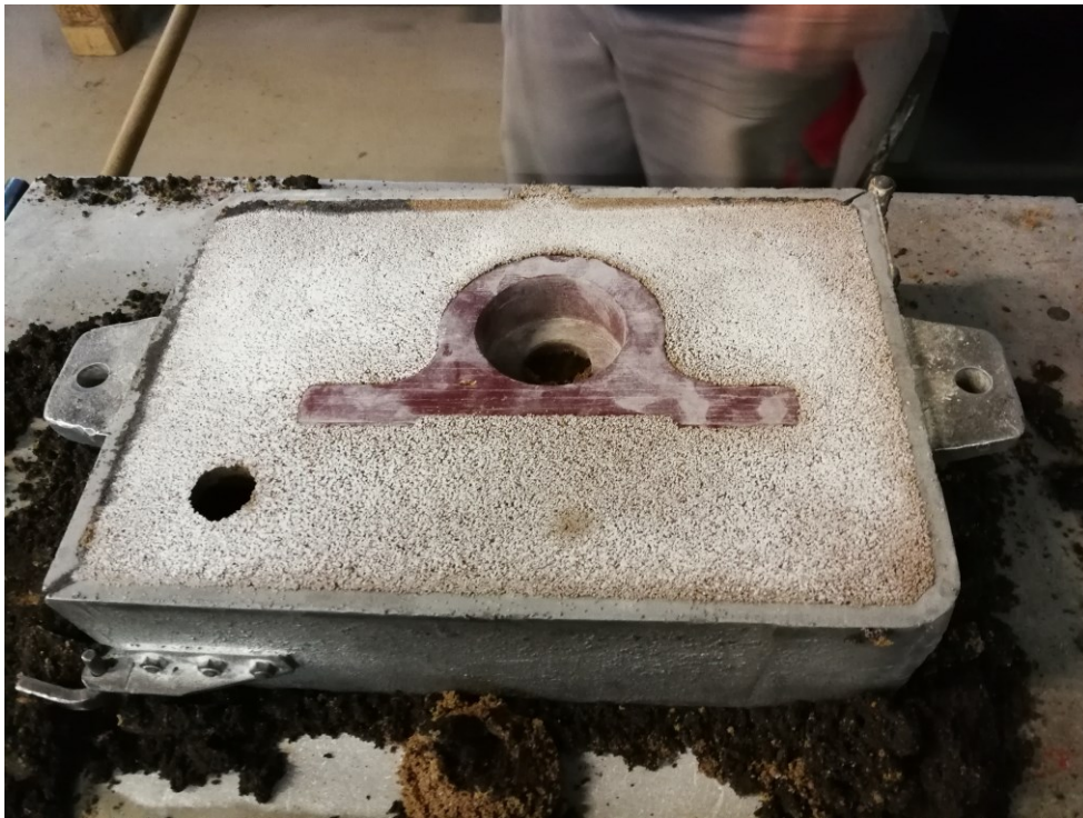
Slika 40. Model odljevka u gornjaku
