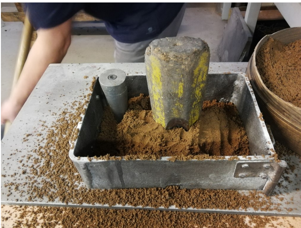
Slika 36. Kalupljenje pojila i spusta u gornjaku
