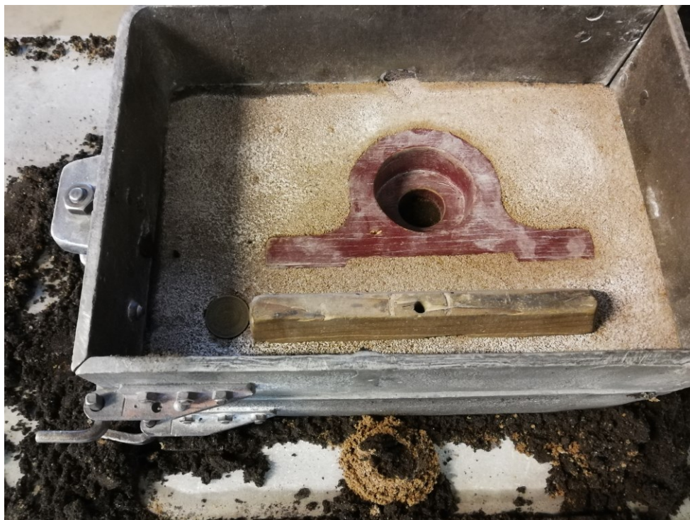
Slika 41. Postavljanje donjaka na gornjak te pozicioniranje razvodnika u donjaku
