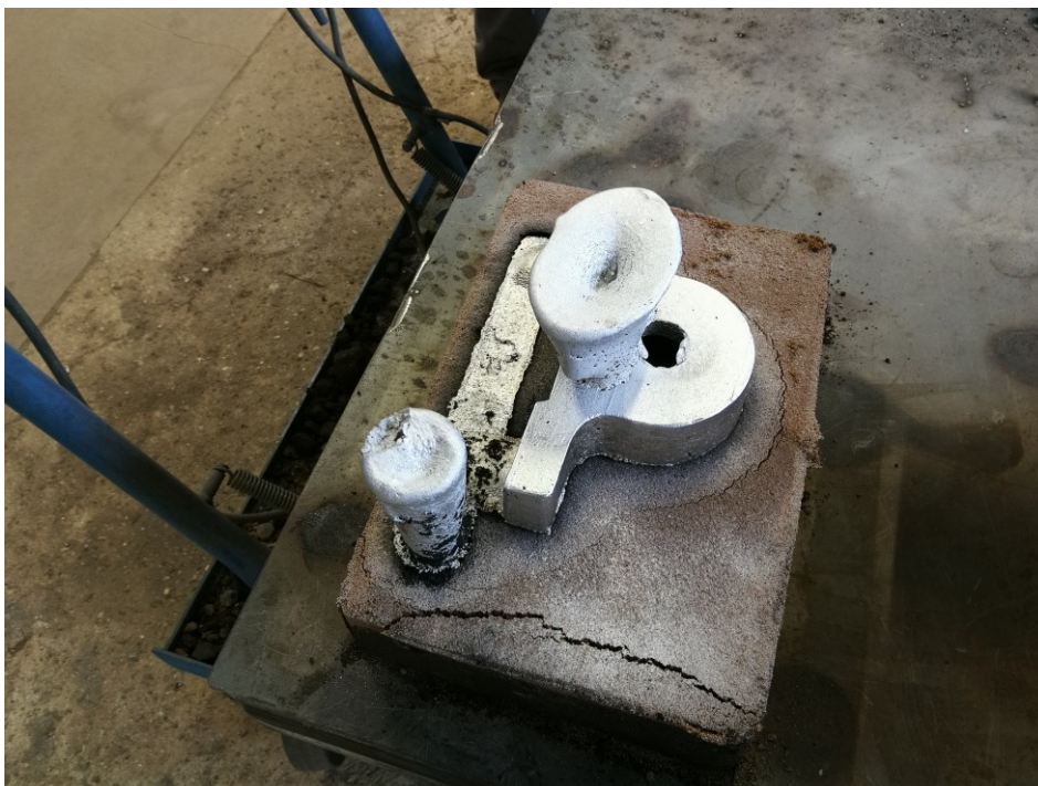
Slika 55. Odljevak i uljevni sustav
