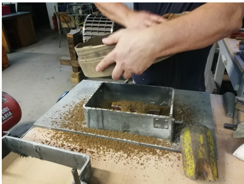
Slika 35. Nasipavanje modelnom kalupnom mješavinom
