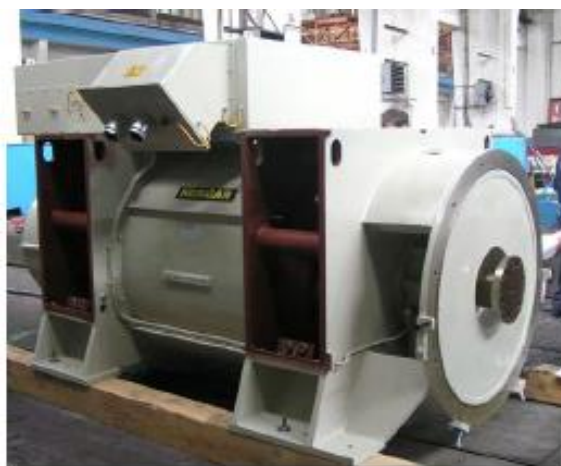
Slika 19. Generator Končar SB1254-4 [16]
