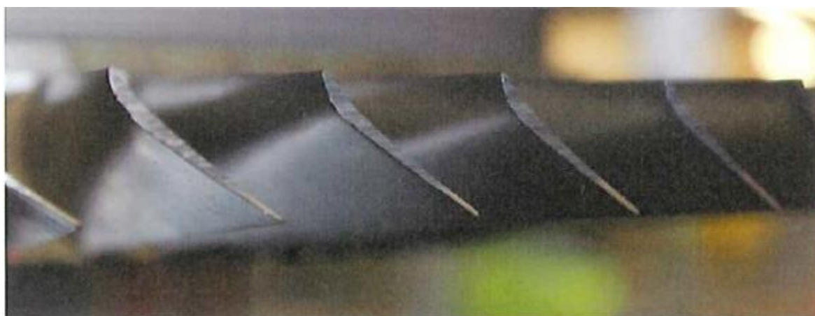
Slika 24. Oštećenja lopatica turbine [19]
