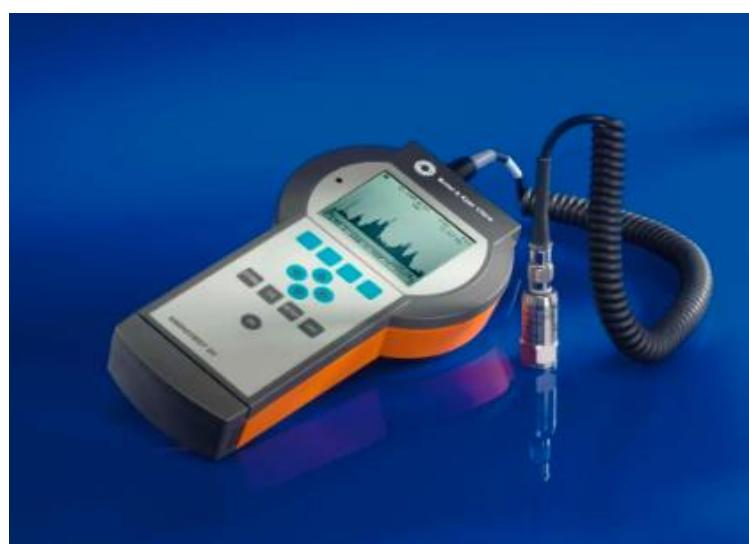
Slika 5. Prijenosni uređaj za mjerjenje vibracija [5]
