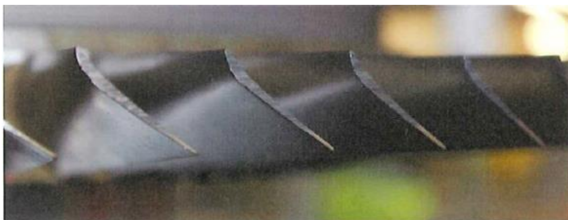
Slika 24. Oštećenja lopatica turbine [19]
