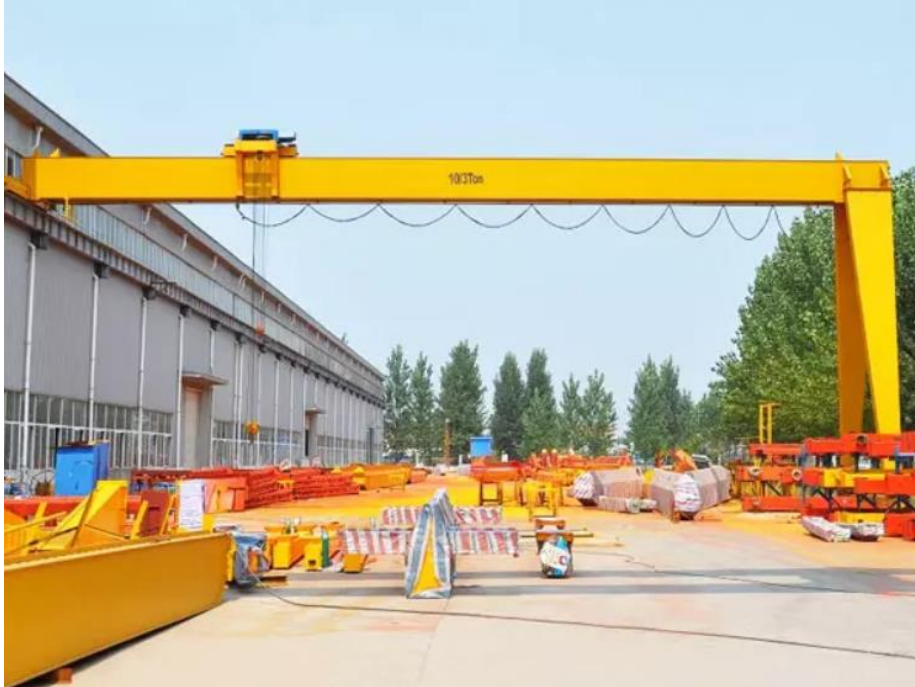
Slika 5. Poluportalni granik s jednim glavnim nosačem tvrtke Henan Hengyuan Crane [3]
