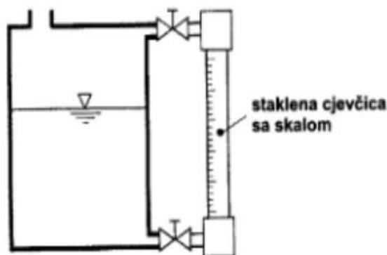
Slika 2. Sustav za mjerenje dubine pomoću staklene cjevčice[3]
