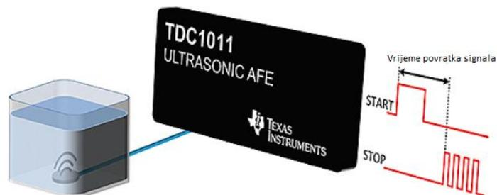
Slika 9. Shema ultrazvučnog mjerila dubine[4]
