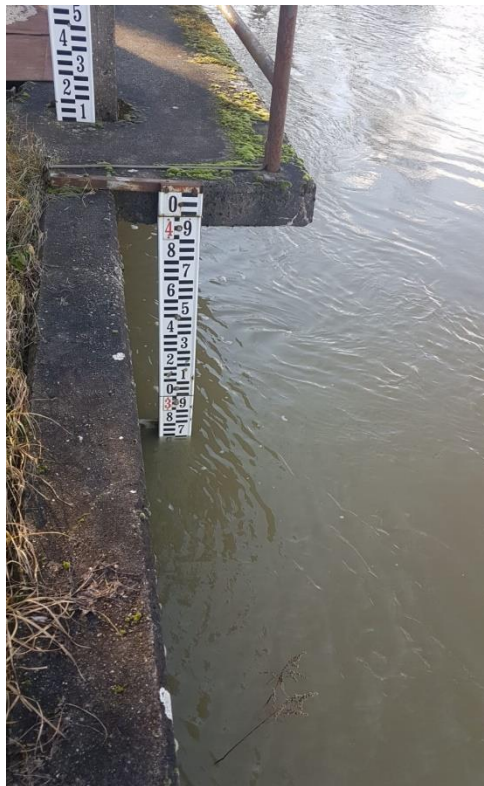
Slika 3. Štapno mjerilo dubine
