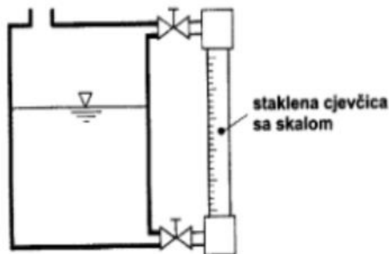
Slika 2. Sustav za mjerenje dubine pomoću staklene cjevčice[3]
