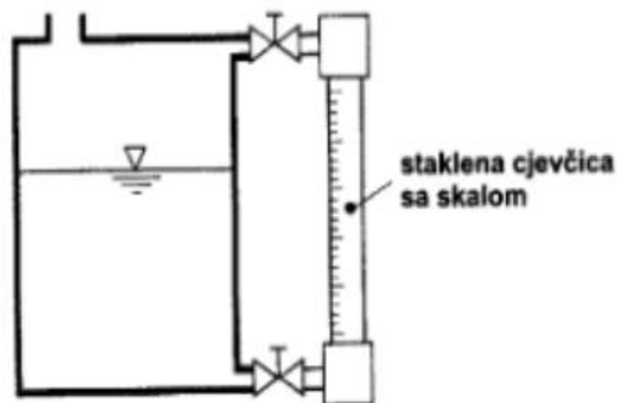
Slika 2. Sustav za mjerenje dubine pomoću staklene cjevčice[3]
