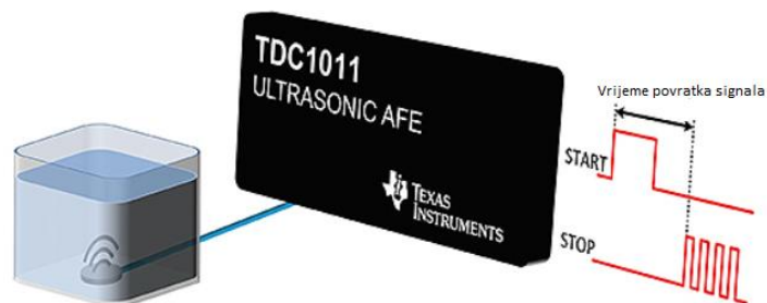
Slika 9. Shema ultrazvučnog mjerila dubine[4]
