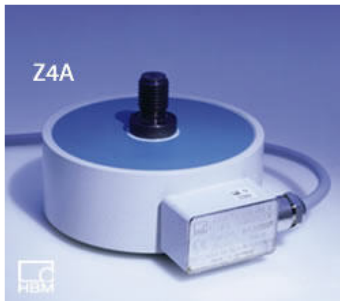
Slika 17 – Posrednički etalon Z4A [17]
