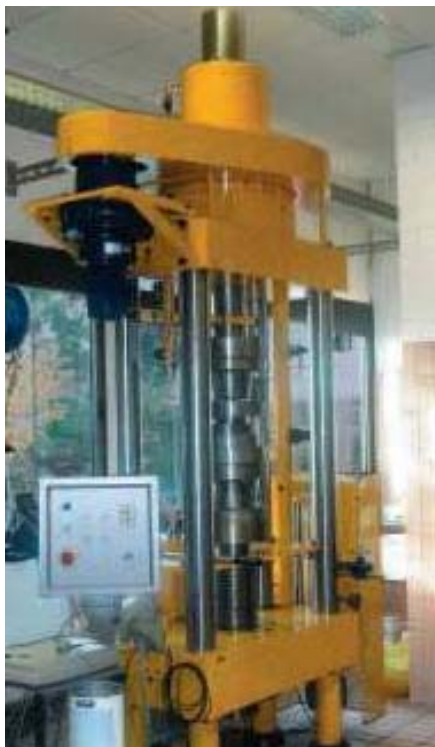
Slika 10 – Referentni etalon sile smješten u LBF-u, Njemačka, s hidrauličnim mehanizmom opterećenja [14]
