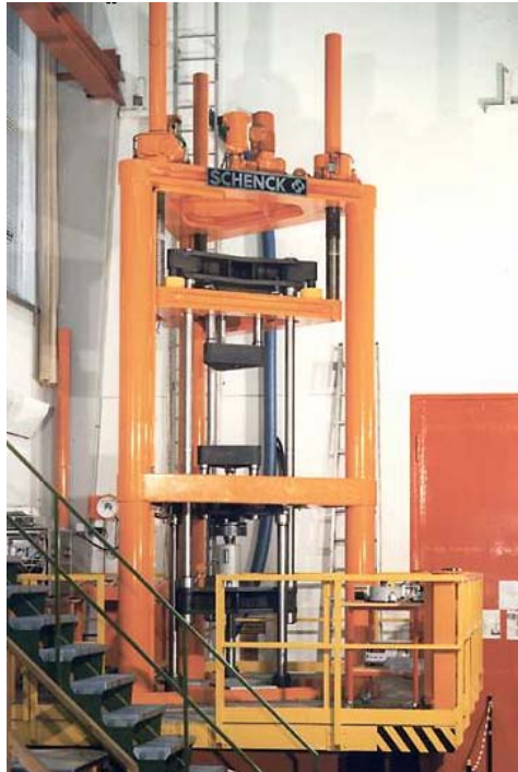
Slika 8 – Primarni nacionalni etalon sile nazivne sile 1 MN smješten u PTB-u, Njemačka [11]
