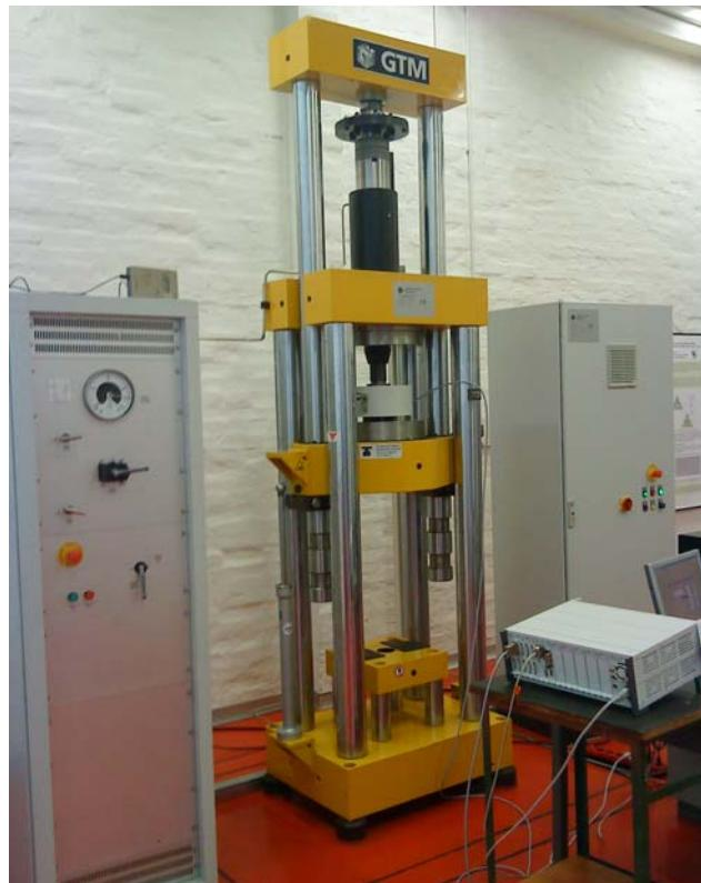
Slika 12 – Referentni etalon sile KBNM-500 kN smješten u LIMS-u
