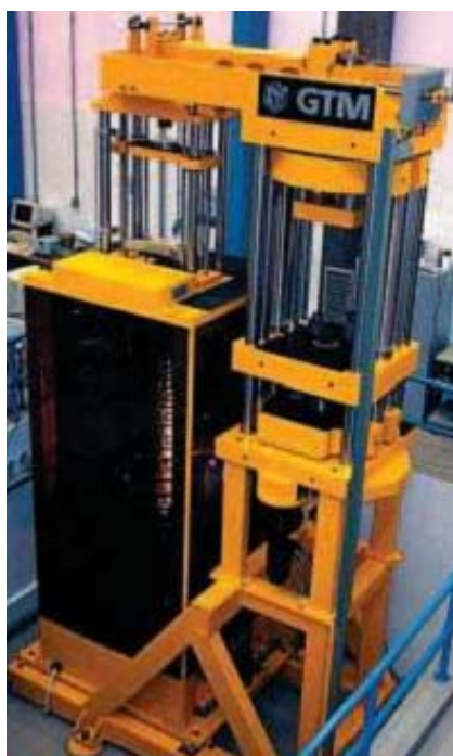
Slika 11 – Referentni etalon sile smješten u EIM-u, Grčka, s polužnim mehanizmom opterećenja [14]
