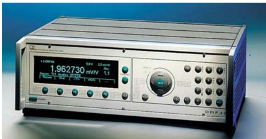
Slika 18 – Mjerno pojačalo DMP 40 [17]
