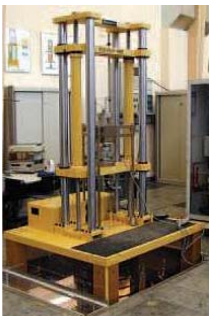
Slika 9 – Referentni etalon sile nazivne sile 100 kN smješten u PTB-u, Njemačka, s direktnim opterećenjem utezima [14]
