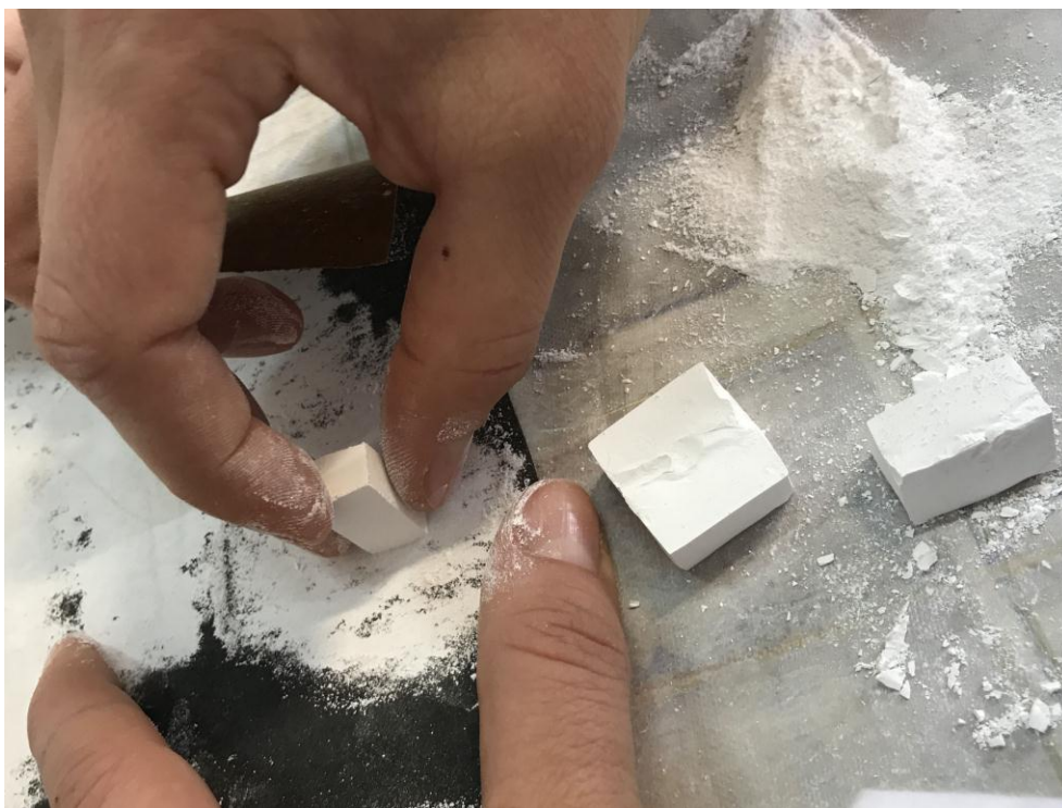
Slika 16. Brušenje sirovaca (zelena obrada)
