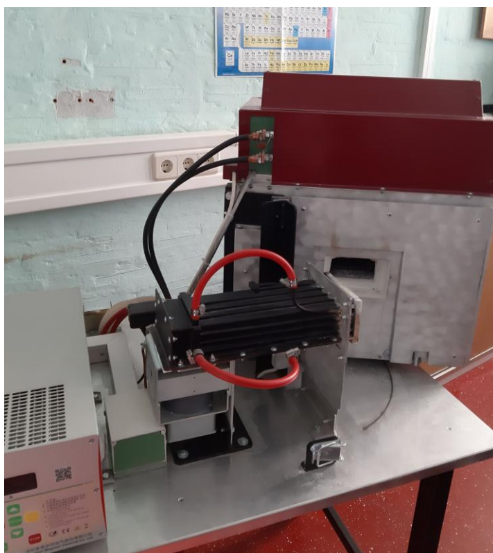
Slika 17. Mikrovalna peć za sinteriranje Wepex 4000B
